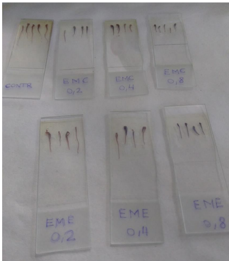
Figura 12: Lâminas contendo raízes de gergelim previamente tratadas com os extratos brutos EMC e EME nas concentrações de 0,2, 0,4 e 0,8 \text{mg.mL}^{-1} , prontas para serem fotografadas em microscópio. (Raíssa Accarini, arquivo pessoal).
