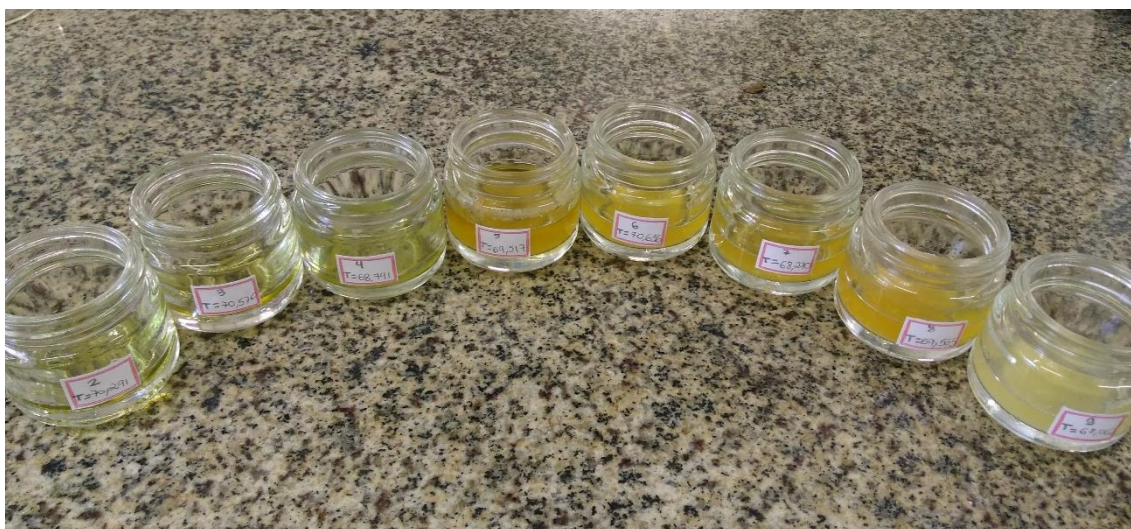
Figura 6: Frações colhidas após fracionamento do extrato bruto em coluna de sílica em fase normal. (Raíssa Accarini, arquivo pessoal).
