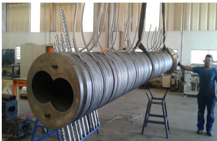
Figura 4.34 - Canhão dupla-rosca produzido com aço V8550M ® . Foto cortesia empresa LGMT de Piracicaba-SP.
