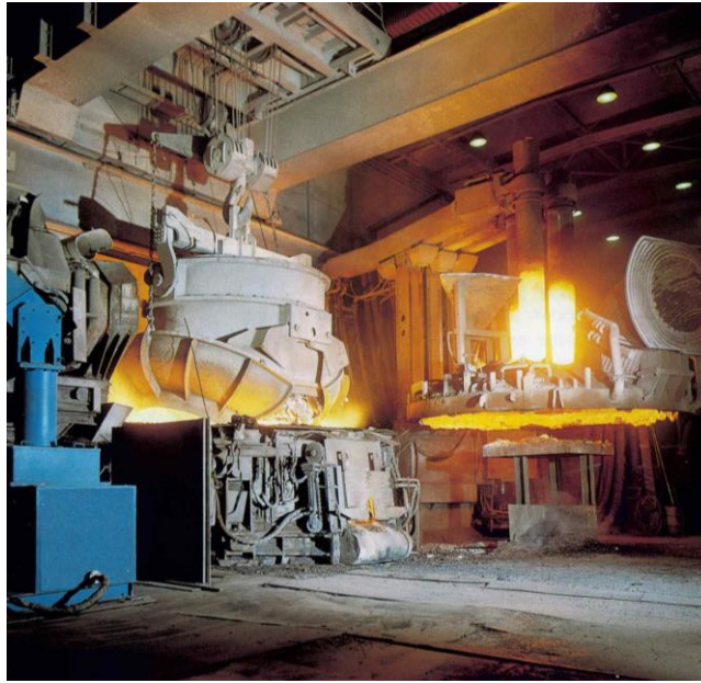
Figura 3.9 - Imagem de um forno elétrico a arco sendo carregado com sucata metálica [3].
