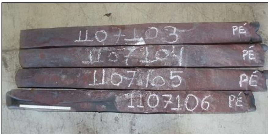
Figura 3.6 - Barras forjadas com secção quadrada de 80 mm a partir dos lingotes de 55kg produzidos em escala piloto.
