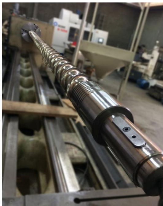
Figura 4.35 - Rosca de extrusora de produzido com aço V8550M ® . Foto cortesia empresa Universaloy de São Bernarado do Campo – SP.
