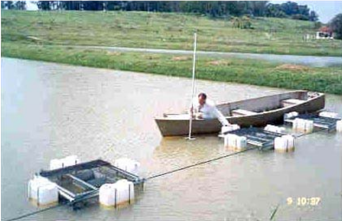
Anexo 8 – Monitoramento da água do viveiro - medição da transparência pelo disco de Secchi
