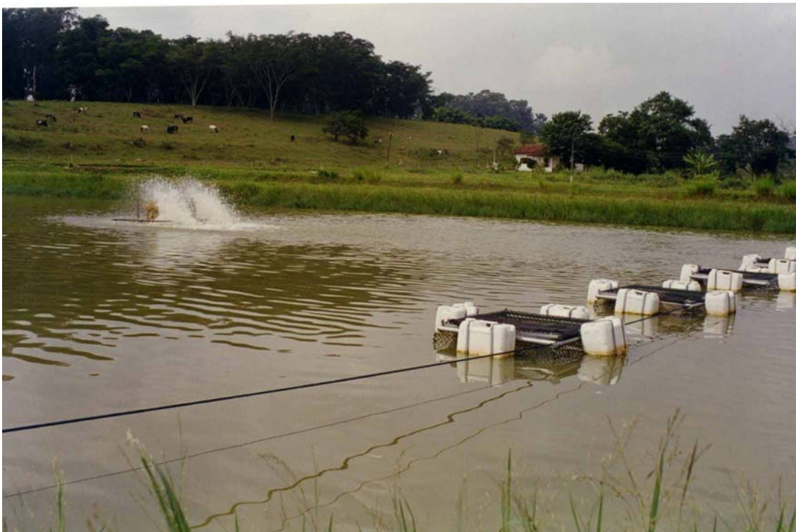
Anexo 9 – Aerador de pás de 1HP instalado no viveiro 1
