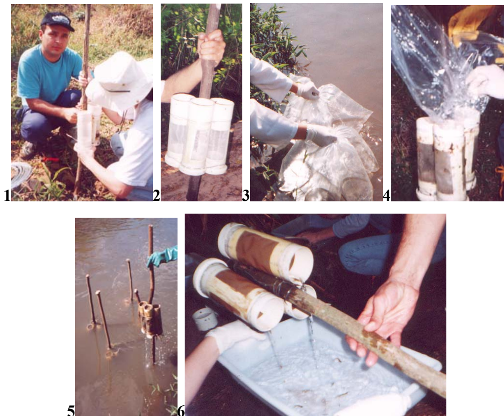
Figura 7: Realização dos testes de toxicidade in situ no rio Monjolinho (1-armadilhas sendo presas a estaca de madeira; 2-armadilhas em número de três para cada espécie; 3-aclimatação dos organismos teste no ambiente ao qual ficariam expostos; 4-introdução dos organismos-teste nas armadilhas; 5- armadilhas no ambiente e retirada após 96hs; 6-avaliação fina e coleta dos organismos com auxílio de uma bandeja plástica e água do próprio ambiente).
