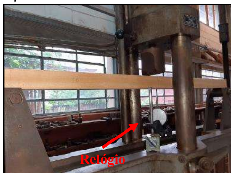
Figura 24. Aferição dos deslocamentos no ensaio de flexão estática.
