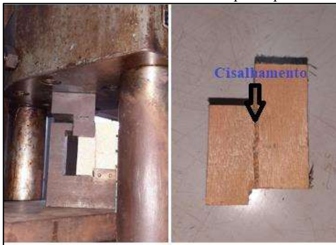
Figura 20. Ensaio de cisalhamento e corpo de prova rompido.
