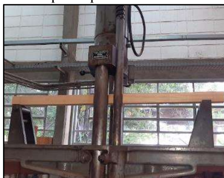
Figura 23. Posicionamento do corpo de prova durante o ensaio de flexão estática.
