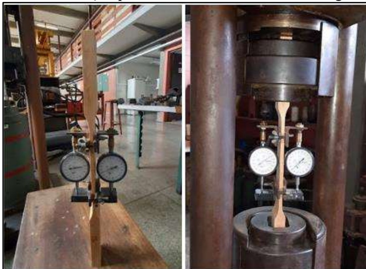
Figura 16. Ensaio de tração paralela às fibras com uso de relógio comparador.
