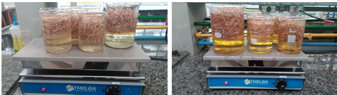
Figura 04: Fervura das fibras em chapa metálica antes e durante o processo.
