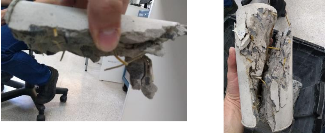
Figura 12: Concreto agarrado na fibra de milho.
