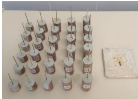
Figura 05: Corpos de prova confeccionados para determinação do comprimento crítico.
