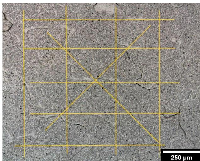
Figura 3.10 – Aplicação do método Heyn dos interceptos lineares (ASTM E112) para determinação de TG
