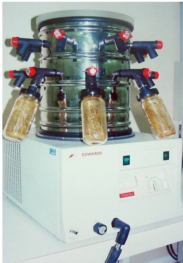
Figura 3.11 – Secagem de extrato de Cambona 4 em liofilizador
