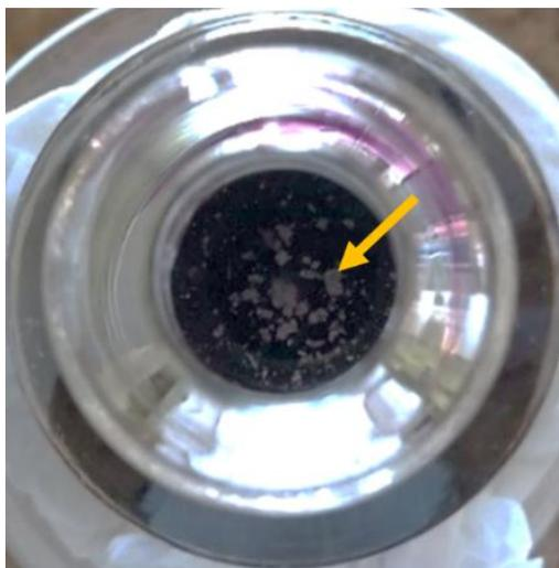
FIGURA 4.2 - Imagem vista de cima do vaso reacional aberto com os produtos da síntese do material LMO-Ni75; em destaque o produto de coloração diferente.
