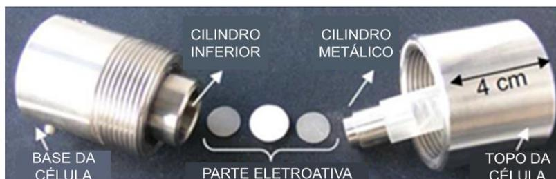
FIGURA 3.5 - Foto ilustrativa da célula eletroquímica utilizada nas caracterizações eletroquímicas.
