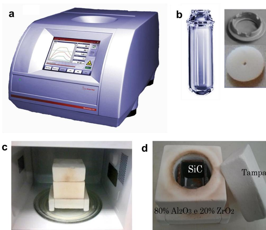
FIGURA 3.1 - Fotos do (a) reator de micro-ondas modelo Monowave 300 da Anton Paar e (b) frasco de reação de boro-silicato, tampa de encaixe e septo de silicone revestido com Teflon® utilizados na etapa de síntese dos espinélios e de troca iônica; e do (c) interior do micro-ondas convencional e do (d) reator utilizados na etapa de tratamento térmico dos espinélios (Fonte: A autora).
