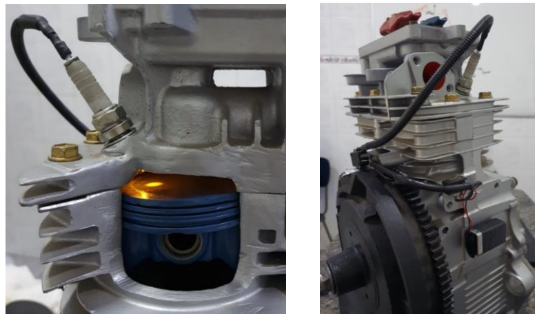
Figura 11 – Fotos mostrando uma lâmpada de LED adaptada na carcaça de uma vela de ignição (superior esquerda) e o correspondente circuito elétrico acoplado ao motor (superior direita) utilizado para acionar a mesma e simular a ignição da mistura ar-combustível na câmara de combustão no momento em que o pistão comprime a mistura no cilindro. Abaixo mostramos a malha do circuito elétrico e os valores dos componentes utilizados.
