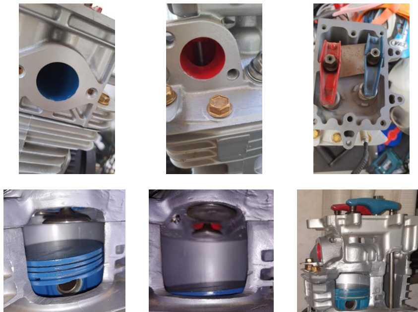
Figura 17 – Fotos mostrando o duto de admissão na cor azul à esquerda, o duto de exaustão em vermelho no centro, pintados para fornecer uma representação visual para os estudantes das menores e maiores temperaturas, respectivamente, do ciclo de Otto. Os balancins à direita também foram pintados nas respectivas cores, pois são responsáveis pela abertura das válvulas de admissão (inferior à esquerda) e exaustão (inferior no centro).
