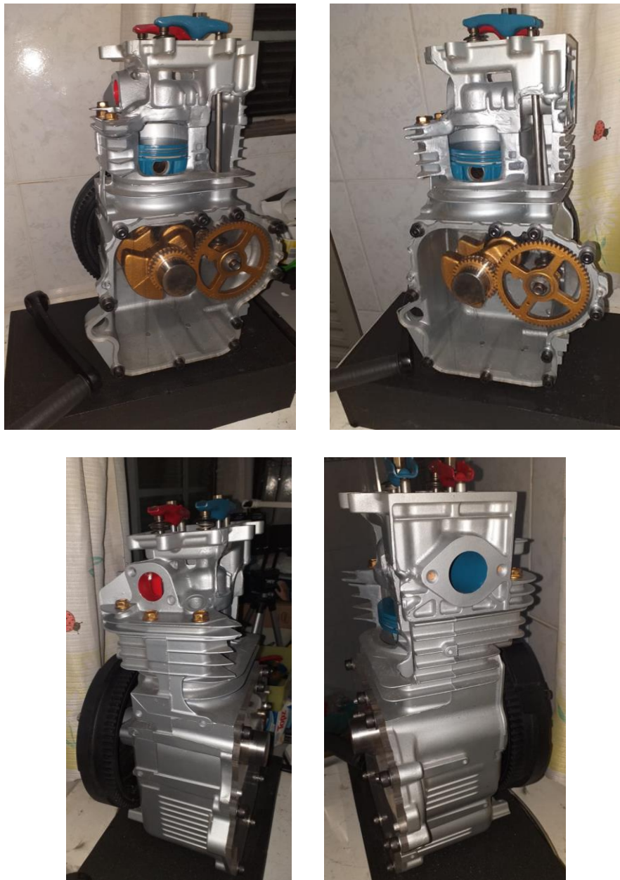
Figura 10 – Fotos em diferentes ângulos do motor pronto para ser utilizado como material didático.
