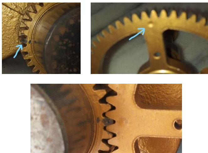
Figura 7 – Fotos mostrando as marcações de fábrica das peças do motor para facilitar a sincronização do sistema.
