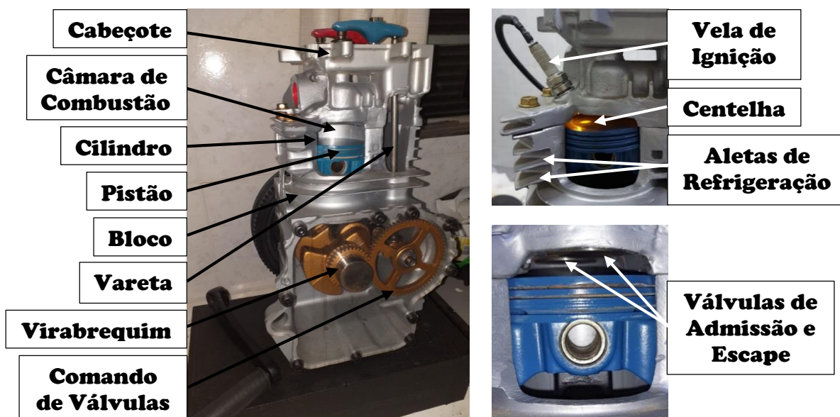
Figura 12 – Fotos mostrando as partes do motor de combustão interna utilizado neste trabalho, conforme a terminologia apresentada nesta seção.
