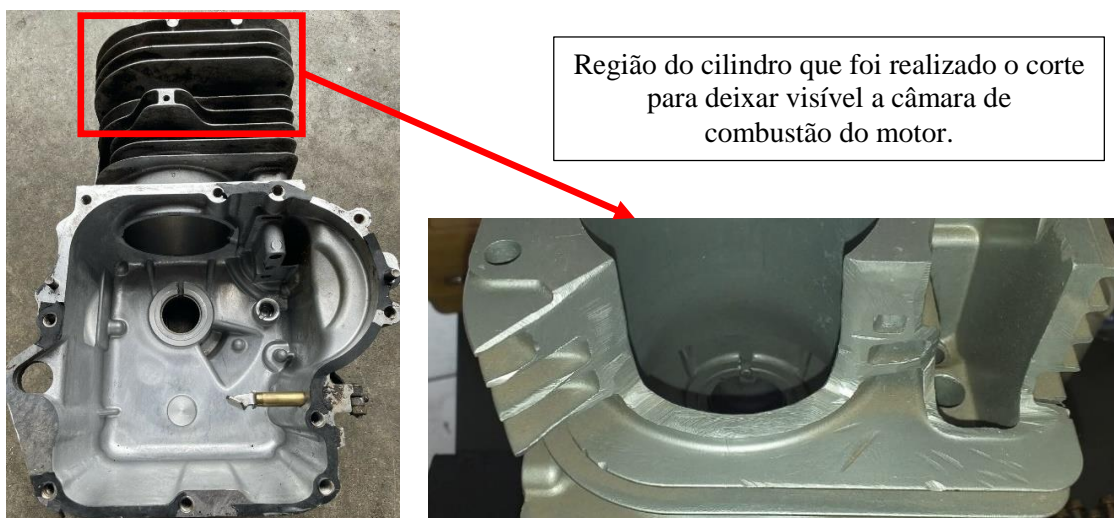
Figura 4 – Foto mostrando uma parte do motor antes e depois do corte transversal feito na região superior do cilindro para facilitar a visualização do movimento do pistão do motor.
