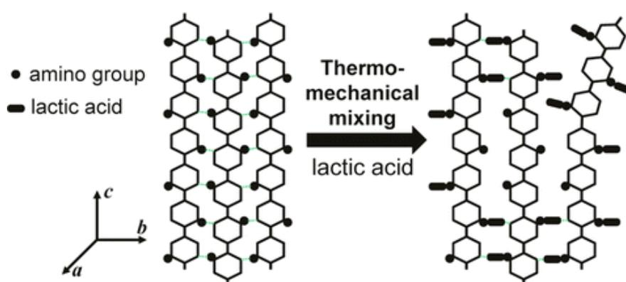
Figura 2.5 – Representação esquemática do mecanismo de desestruturação da quitosana sob ação do cisalhamento imposto durante o processamento mecânico. Imagem extraída da referência [1].
