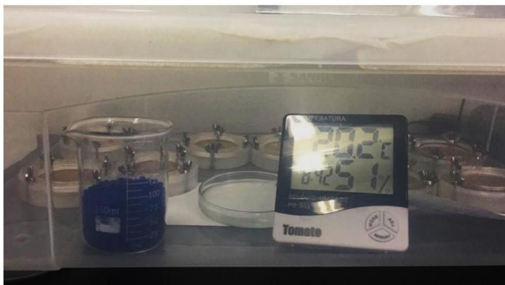
Figura 3.4 – Imagem de uma cápsula montada para ensaio PVA contendo uma placa AC15 (superior) e uma caixa de PP no início do ensaio de PVA (inferior).
