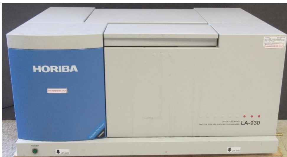
Figura 3.7 – Equipamento utilizado para obtenção das distribuições granulométricas, Laser Scattering Particle Size Distribution Analyzer 930 da marca Horiba .
