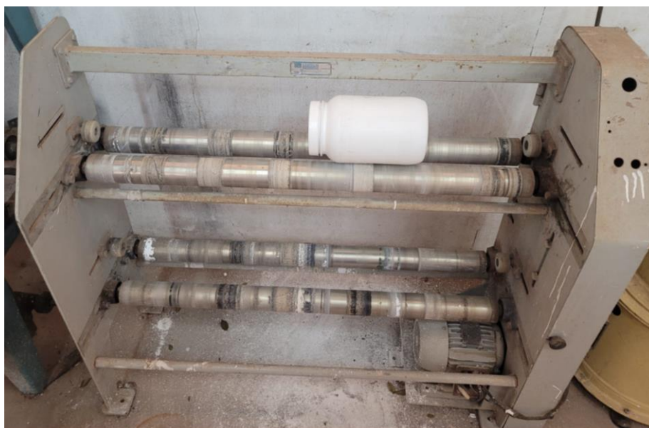
Figura 3.6 – Misturador mecânico utilizado para realizar a mistura e homogeneização do pó metálico.
