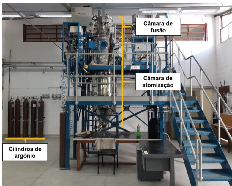
Figura 3.4 - Atomizador a gás (Gas Atomiser HERMIGA 75/5VI (EAC) - PSI-Phoenix Scientific Industries Ltd. ) utilizado neste trabalho.
