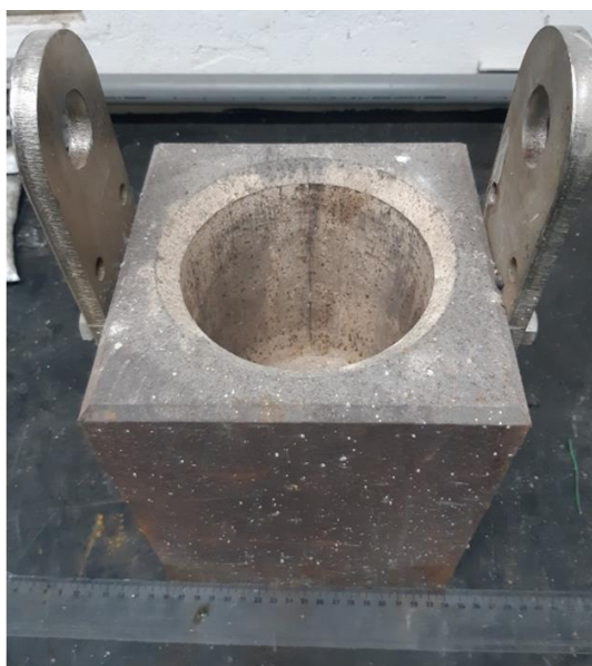
Figura 3.2 - Molde metálico utilizado para transferir o metal líquido ( \varnothing = 125 mm e h = 170 mm).
