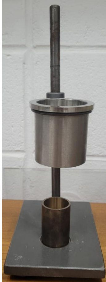
Figura 3.11 – Conjunto utilizado para obtenção da densidade aparente a partir do funil de Carney.
