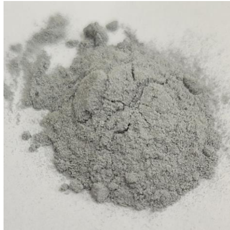
Figura 3.5 – Pó metálico da liga de alumínio AA2017 produzido por atomização a gás.
