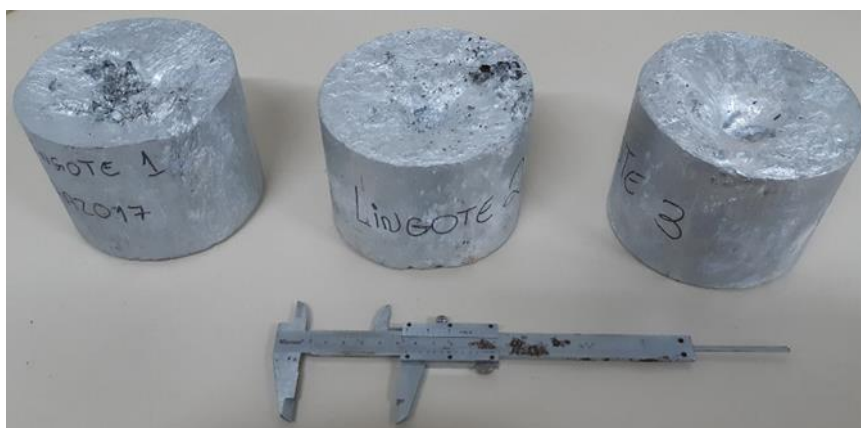
Figura 3.3 - Lingotes de AA2017 após retirada do molde metálico.
