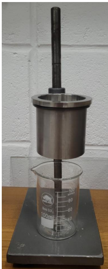
Figura 3.10 – Conjunto utilizado para obtenção da fluidez a partir do funil de Carney.
