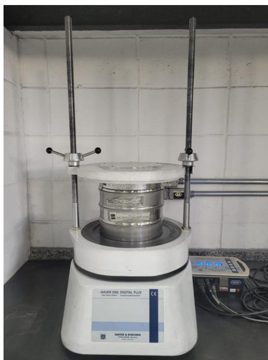
Figura 3.8 – Equipamento “Haver EML Digital Plus – Test Sieve Shaker” da marca Haver & Boecker em conjunto com as peneiras para classificação granulométrica.
