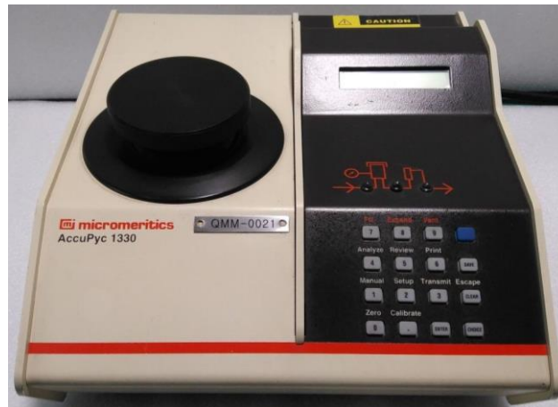
Figura 3.12 – Equipamento AccuPyc 1330 – Micromeritics para obtenção da densidade esquelética das partículas atomizadas a gás.
