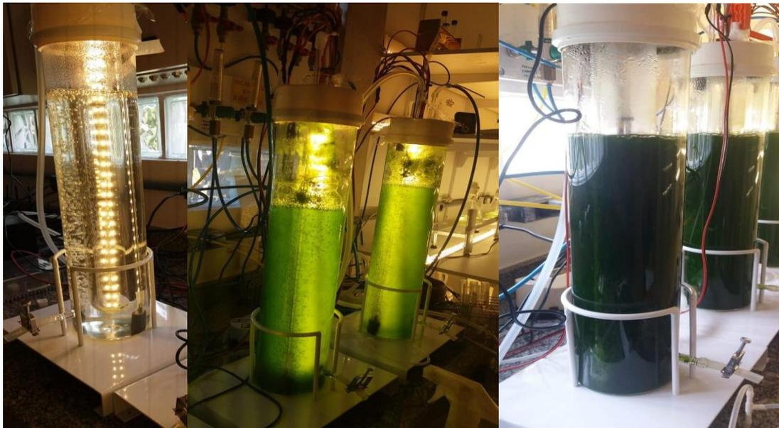
**Figura 1.** Fotobiorreator cilíndrico de alto desempenho com iluminação interna em diferentes fases de cultivo.
