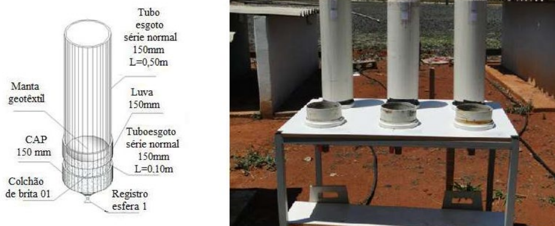
Figura 23 - (a) Esquema do Leito de drenagem utilizado por Santos, (2012). (b) Foto do Leito de drenagem utilizado por Santos (2012)
