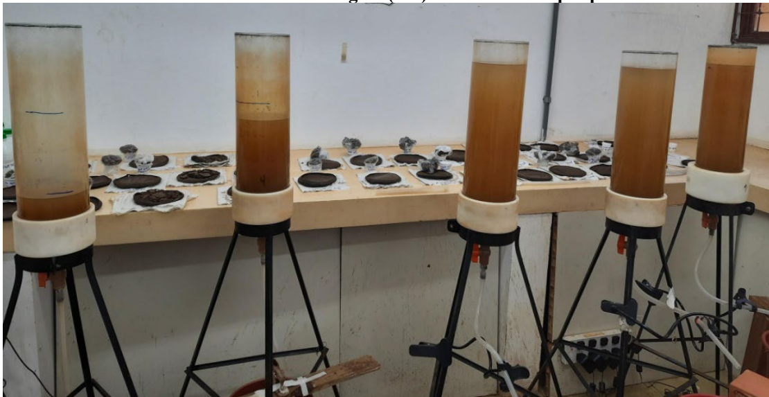
Figura 33 - Foto dos cinco tubos de acrílico em funcionamento do Sistema de desaguamento de lodo em Leito de Drenagem (LD) utilizado nesta pesquisa
