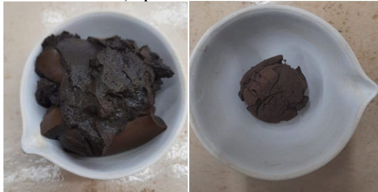
Figura 43 - Aspecto do lodo a) lodo úmido que foi raspado do geotêxtil acondicionado no cadinho e b) aspecto do lodo seco
