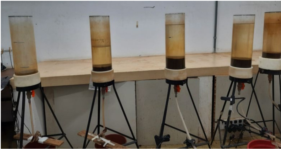
Figura 38 - Fotografia de ensaio com o GTNT400 CP-cone a) com H10, H30 e H50 cm b) água drenada para H50 cm e c) aspecto do lodo retido
