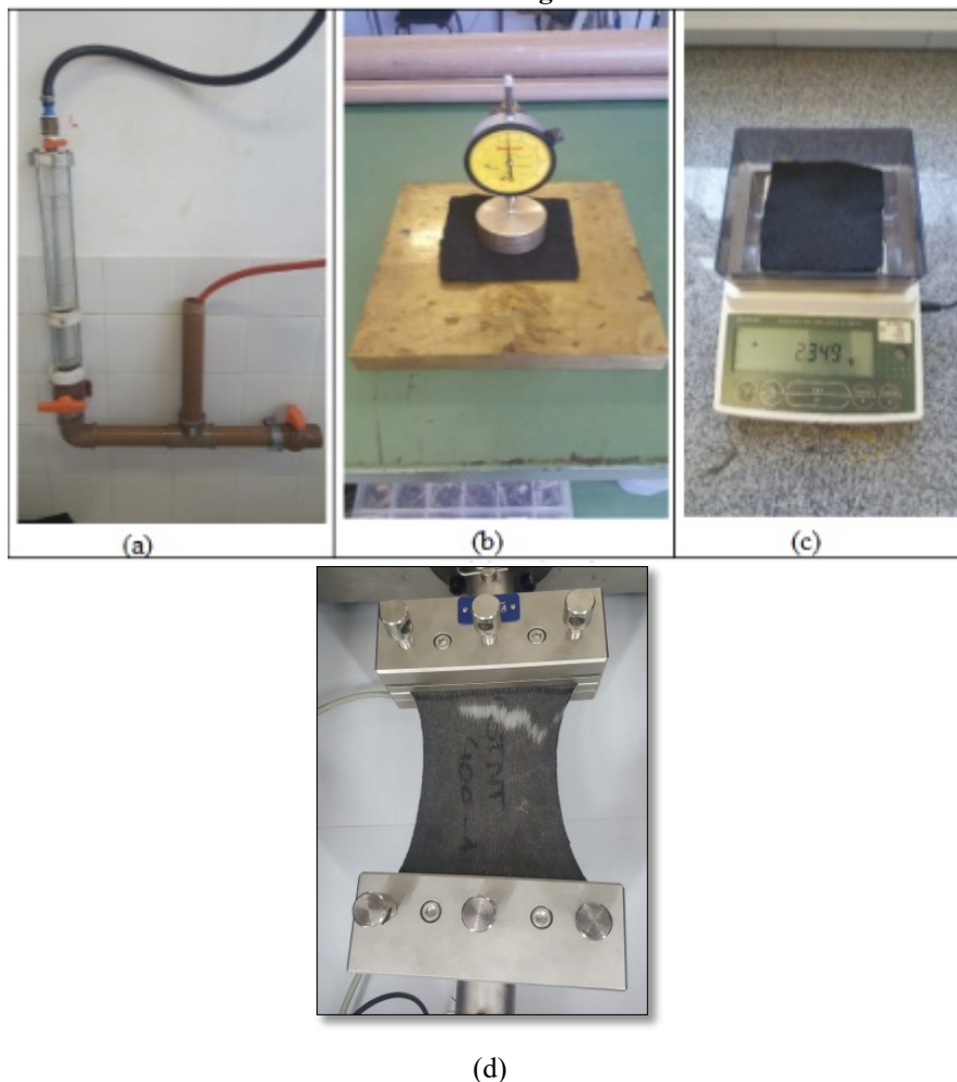
Figura 41 - Equipamentos utilizados para ensaios de caracterização dos geotêxteis (a) ensaio de permissividade (b) ensaio de espessura (c) ensaio de massa por unidade de área (d) ensaio de tração a faixa larga
