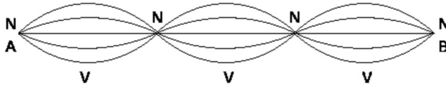
A extremidade A está presa a um oscilador que vibra com pequena amplitude. A extremidade B é fixa e a tração na corda é constante. Na situação da figura, onde aparecem três ventres (V) e quatro nós (N), a frequência do oscilador é 360 Hz. Aumentando-se gradativamente a frequência do oscilador, observa-se que essa configuração se desfaz até aparecer, em seguida, uma nova configuração de ondas estacionárias, formada por
