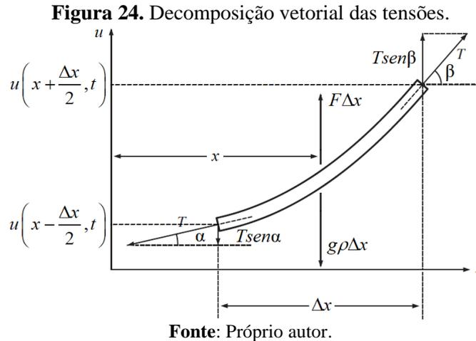
Para um trecho arbitrário do fio distendido na Figura 24, a segunda lei de Newton aplicada ao elemento  $\Delta x$ , nos indica que, a interação da força externa total, devido à força de tensão nas extremidades desse elemento  $\Delta x$ , deve ser igual ao valor do produto da massa, pela aceleração do centro de massa do fio. Como não há aceleração na direção horizontal, as componentes horizontais para qualquer instante de tempo  $t$ , satisfazem a seguinte condição,
