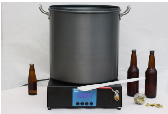
Figura 9. Painel de produção de mosto cervejeiro. Fonte: Arquivo pessoal do pesquisador.
