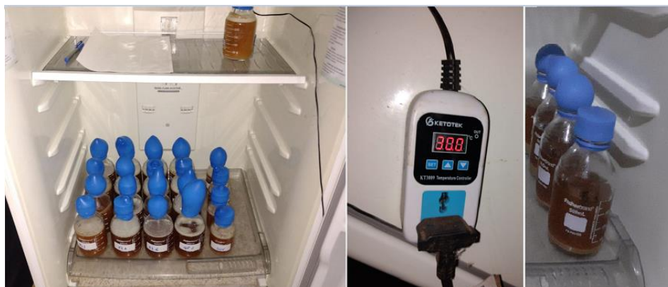
Figura 12. Fermentação experimental realizada em frascos Schott estéreis com um mosto comum de 11°P e variando a cepa de levedura inoculada F1.1, F1.2, F1.6, F2.5, GP2 e S04. Fonte: arquivo pessoal do pesquisador.
