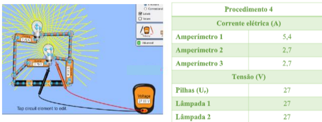
Figura 4. 20. Circuito em paralelo com duas lâmpadas e tabela de medidas elaboradas pelo aluno D
