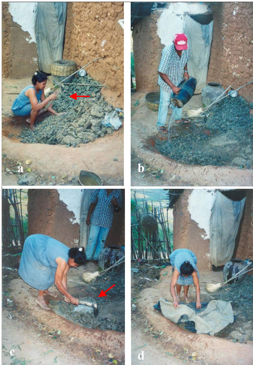
Figura 11. “Loiceira” e seu esposo elaborando a pasta (“barro amassado”) para confecção de “loça de barro” na Chã da Pia: (a) destorroando; (b) umedecendo; (c) homogeneizando; (d) cobrindo com lona plástica.
