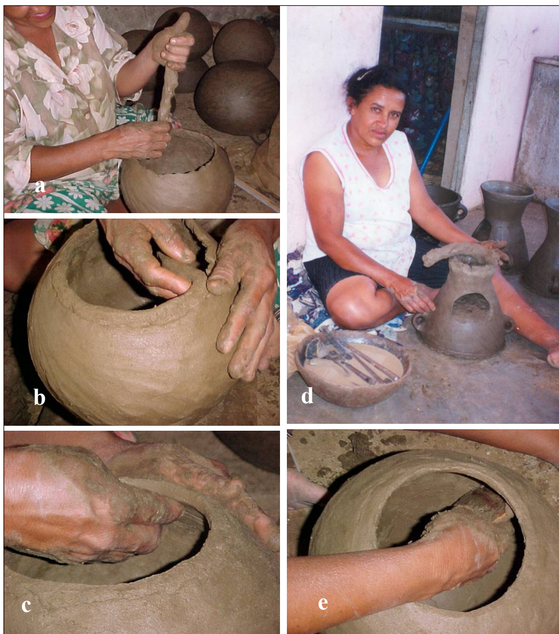
Figura 14. “Loiceira” confeccionando panela na Chã da Pia: (a,b,c) elaboração e colocação do rolete para formação da boca ou “beicho” do vaso; (d) uso do rolete na formação de fogareiro, (e) tratamento da superfície interna da panela com uma pá, fragmento de fruto de cuité (Cucurbitaceae).
