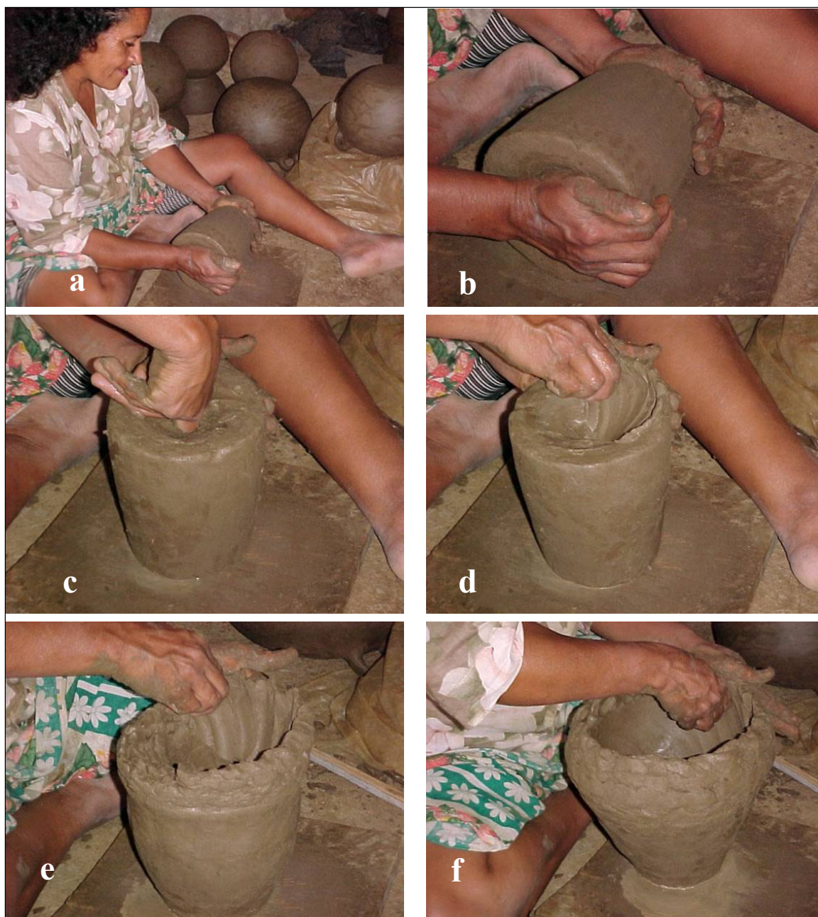
Figura 13. “Loiceira” confeccionando panela na Chã da Pia (etapas iniciais da modelagem): (a,b) elaboração de uma massa (“bolo”) em forma de cone; (c,d,e,f) transformação da massa inicial em um cone oco invertido, por meio de incisões com os dedos.
