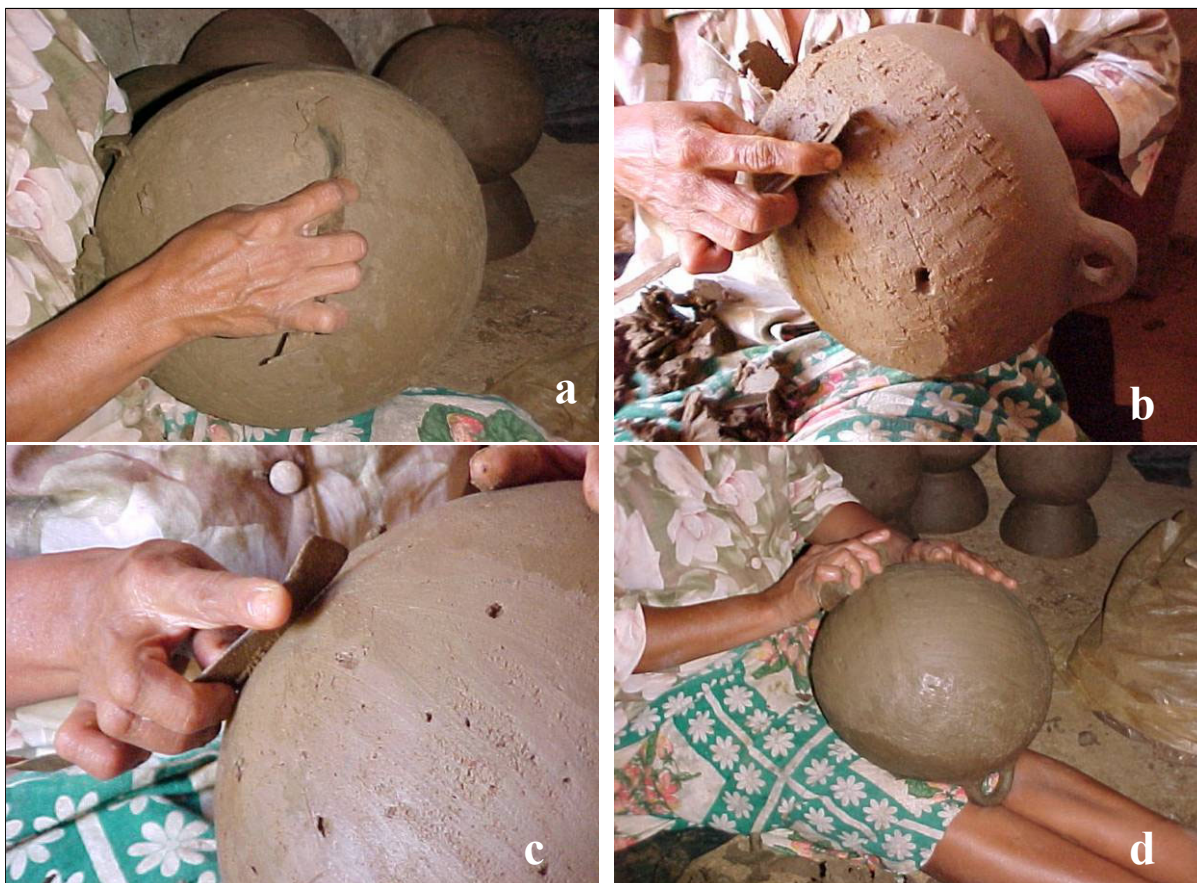
Figura 17. “Loiceira” confeccionando panela na Chã da Pia (tratamentos de superfície): (a,b) “rapando”; (c,d) “grosando”. Em ambas as operações usam-se implementos metálicos (“aspas”). Para “rapar”, uma mão permanece dando apoio por dentro da panela, enquanto a outra opera externamente (a,b), enquanto para “grosar” trabalha-se com as duas mãos na superfície externa da vasilha (c,d).
