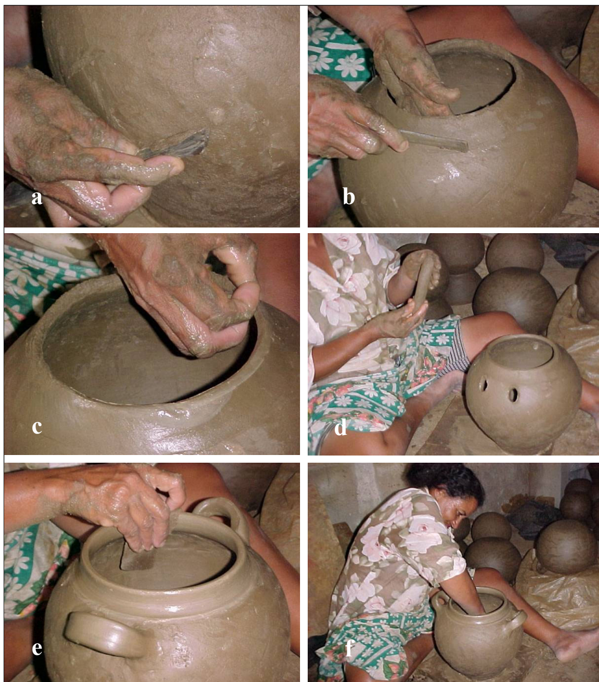
Figura 15. “Loiceira” confeccionando panela na Chã da Pia (tratamentos de superfície): (a,b) uso de “grosadeira” ou “aspa”, elaborada a partir do caule do facheiro ( Pilosocereus sp) ou de agave ( Agave sisalana ), para tratamento da superfície externa e da boca do vaso; (c,e) refinamento da borda, diretamente com os dedos e com auxílio de couro; (d) formação do rolete que dará origem à alça (“asa”); (f) adensamento do fundo (“pé”) do vaso, visando dar mais estabilidade ao conjunto
