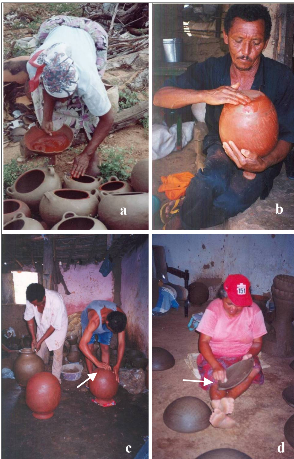
Figura 19. “Loiceiros” confeccionando vasos na Chã da Pia (tratamentos de superfície): (a,b) aplicação parcial e integral de solução aquosa de “toá” (petroplintita); (c,d) uso de seixos de quartzo rolado (setas) para engobar e brunir.
