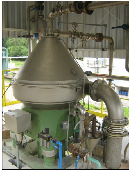
Figura 16 - Centrífuga utilizada durante a execução dos ensaios industriais
