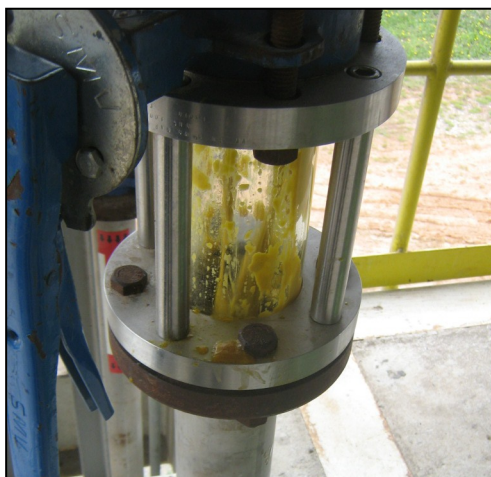
Figura 32 - Visor de linha da saída de goma úmida do sistema de recuperação
