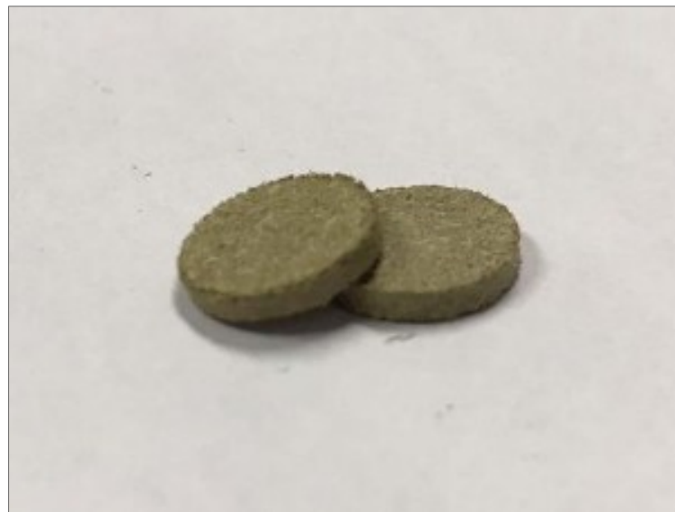
Figura 6.7: Amostra de folha após prensagem (pastilha)
