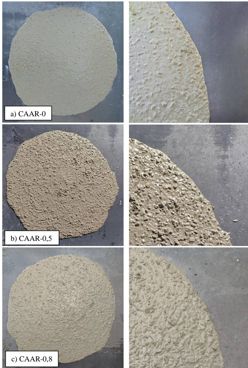
Figura 6.8 - Concretos após ensaio de espalhamento a) CAAR-0; b) CAAR-0,5 e c) CAAR-0,8.
