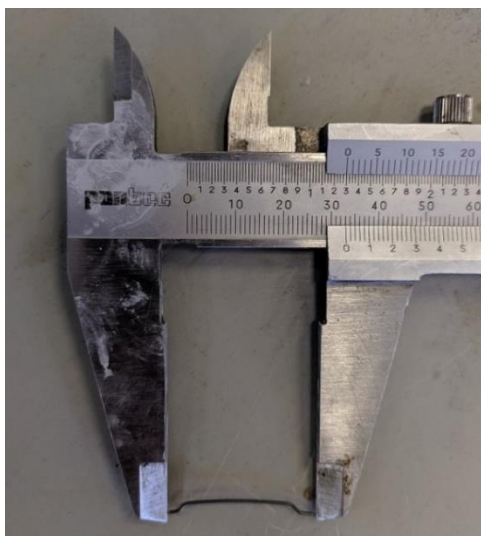
Figura 5.4 - Aferição do comprimento da fibra de aço utilizada.
