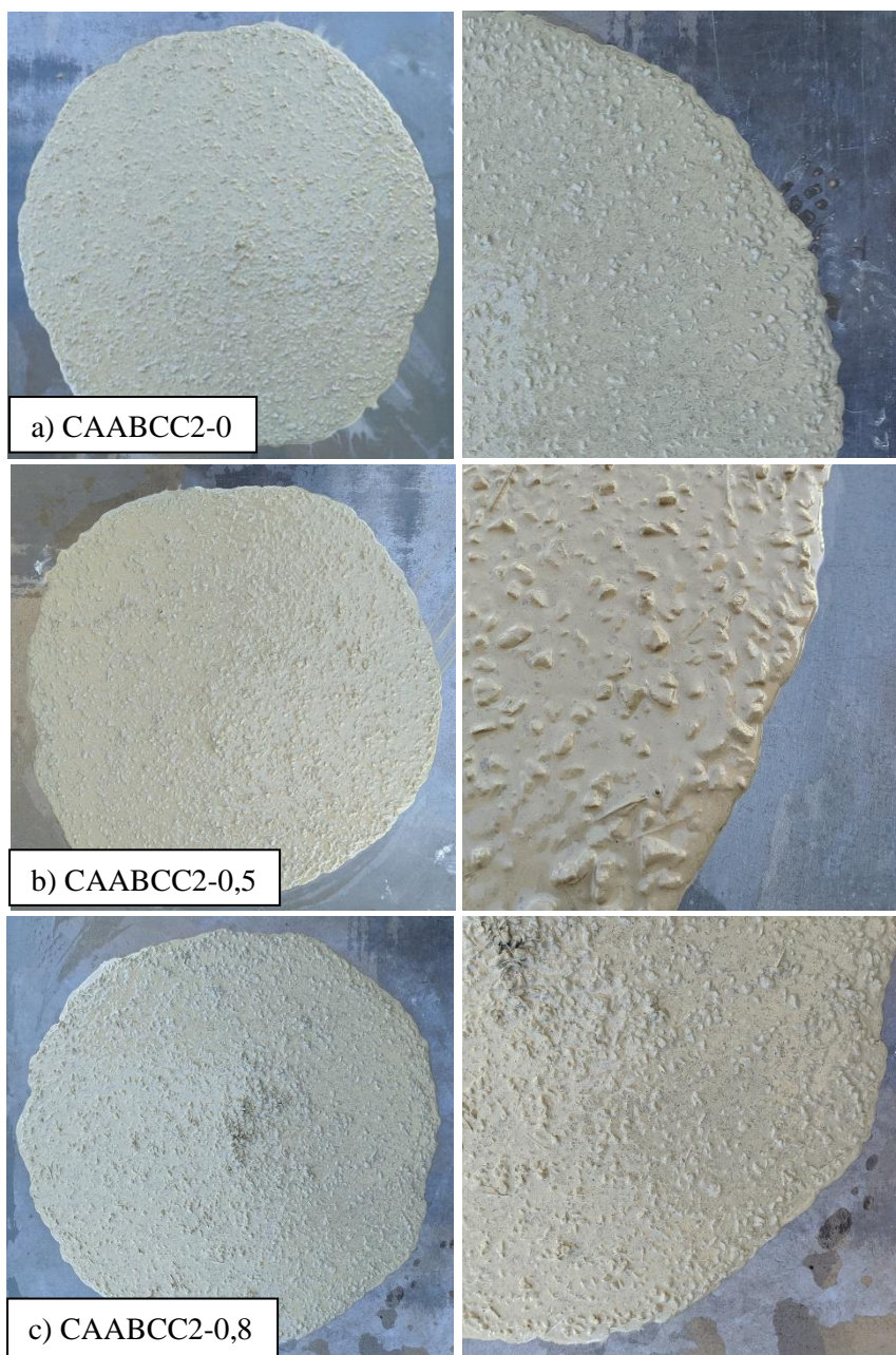
Figura 6.10 - Concretos após ensaio de espalhamento a) CAABCC2-0, b) CAABCC2-0,5 e c) CAABCC2-0,8.
