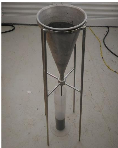
Figura 5.5 - Funil Marsh utilizado no ensaio
