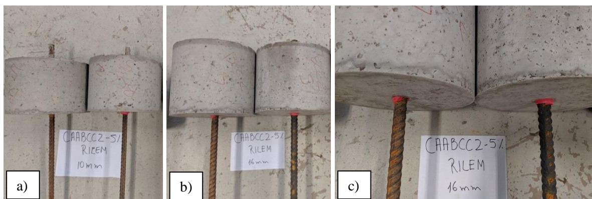
Figura 6.30 – Corpos de prova após ensaios de arrancamento do CAABCC2-0,5
