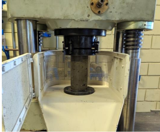
Figura 5.9 – Corpo de prova submetido ao ensaio de resistência à compressão axial.
