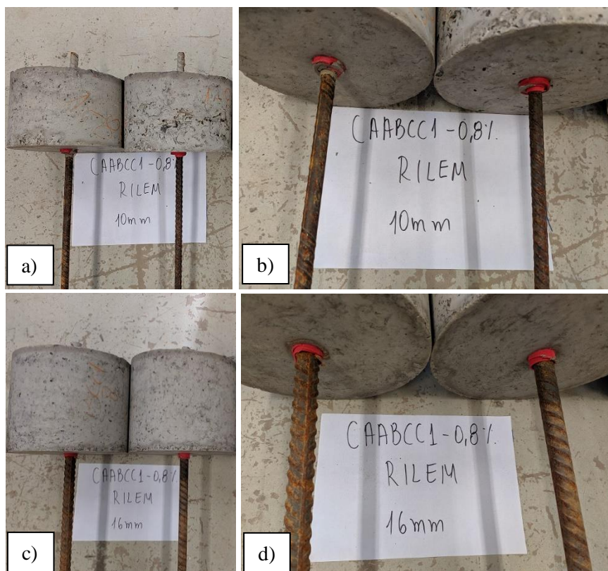
Figura 6.26 – Corpos de prova após ensaios de arrancamento do CAABCC1-0,8
