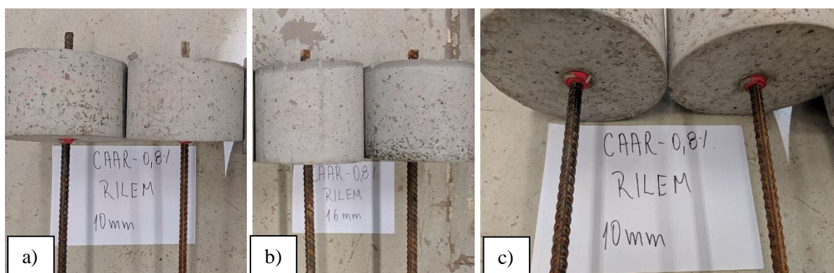
Figura 6.20 – Corpos de prova após ensaios de arrancamento do CAAR-0,8
