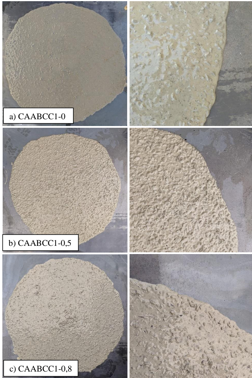
Figura 6.9 - Concretos após ensaio de espalhamento a) CAABCC1-0, b) CAABCC1-0,5 e c) CAABCC1-0,8.
