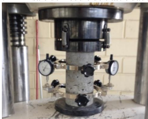
Figura 5.11 - Ensaio de módulo de elasticidade estático.
