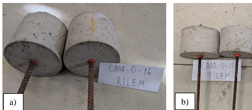
Figura 6.16 – Corpos de prova após ensaios de arrancamento CAAR-0
