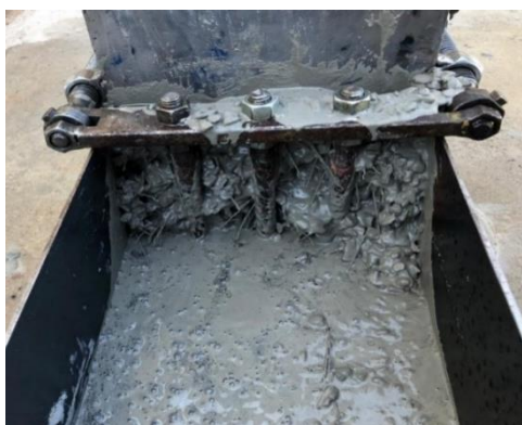
Figura 6.4 – Obstrução durante ensaio de caixa-L gerado por fibras de aço.
