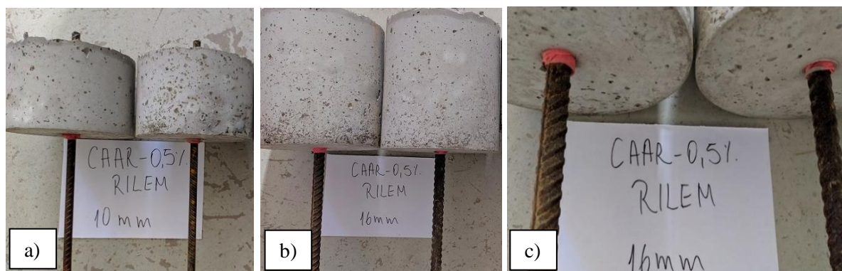
Figura 6.18 – Corpos de prova após ensaios de arrancamento do CAAR-0,5
