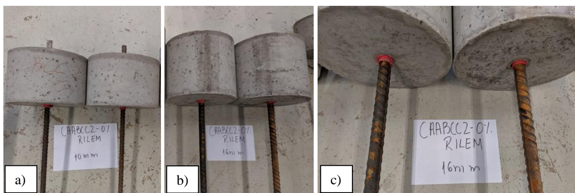
Figura 6.28 – Corpos de prova após ensaios de arrancamento do CAABCC2-0
