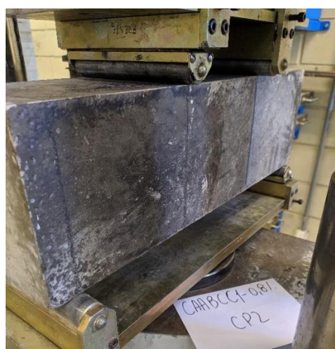
Figura 5.12 – Corpo de prova submetido ao ensaio de tração na flexão.
