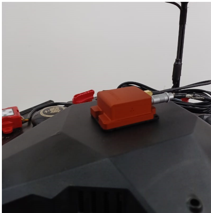
Figura 24 – IMU com um receptor GNSS integrado Xsens modelo MTI-G-710 acoplada no UAV.
