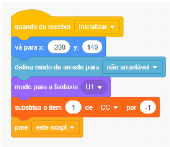
Figura 2.20 – Script de posicionamento e setup da fantasia do Personagem C1
