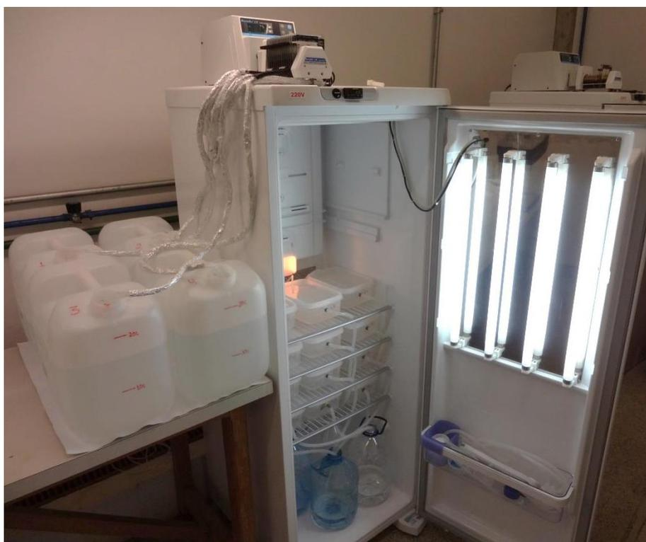
Figura 3 - Disposição dos recipientes de cultivos (dentro da incubadora), da bomba peristáltica (acima), dos tanques com meio de cultivo (à esquerda) e dos tanques com efluentes (dentro e a baixo da incubadora).
