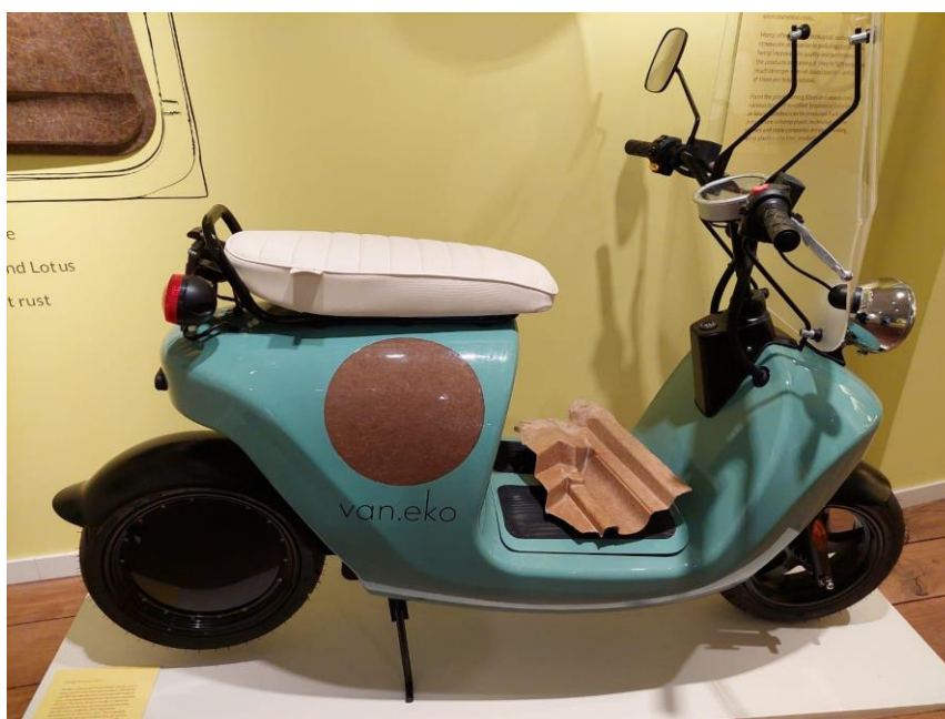
Figura 2 – Estrutura de motocicleta em fibra de cânhamo
