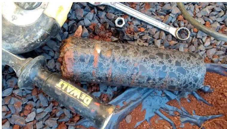
Figura 22 - Testemunho retirado da sapata
