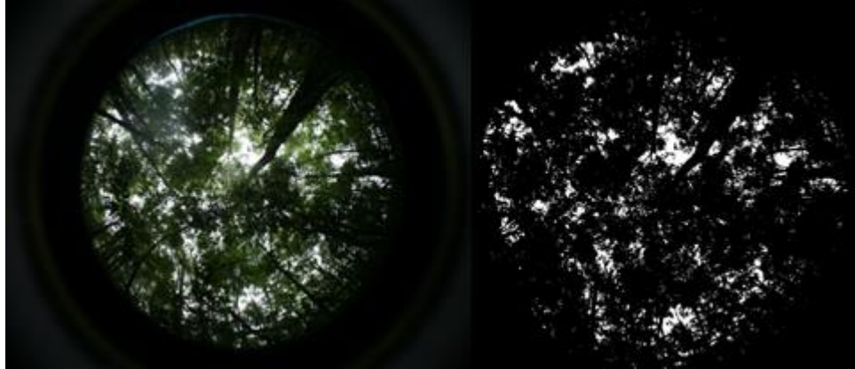
Figura 16: À esquerda imagem original tomada para cada uma das 64 parcelas avaliadas e à direita a mesma imagem após ser tratada no programa Gap Light Analyzer®.
