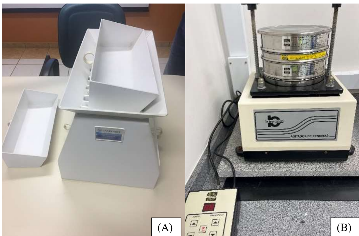
FIGURAS 2 E 3 Quateador tipo Jhones (item A) e agitador de peneiras (item B).
