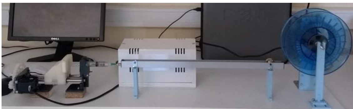
Figura 4.4 – Sistema de fiação contínua, controlado por Arduino, disponível no laboratório Laboratoire Génie des Procédés Papetiers (LGP2) da Université Grenoble Alpes (UGA) na cidade de Grenoble – França, com banho de complexação iônica e roleta de coleta de material.
