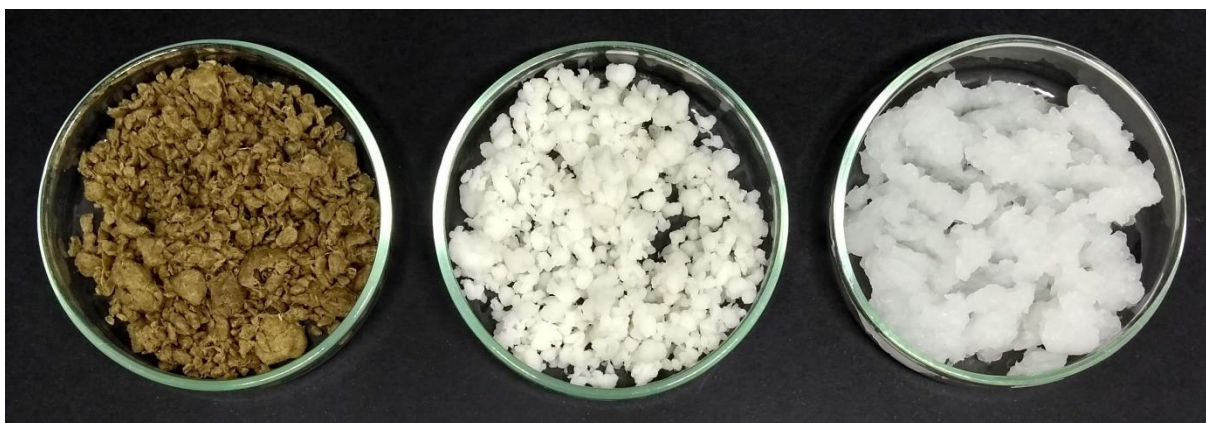
Figura 5.1 – Da esquerda para direita: imagens das polpas de celulose após os processos de polpação Organosolv, branqueamento e oxidação mediada por TEMPO.
