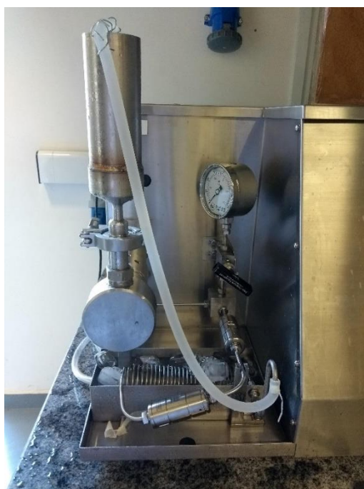
Figura 4.2 – Microfluidizador de bancada e adaptação utilizada para otimizar o processo de múltiplos ciclos.
