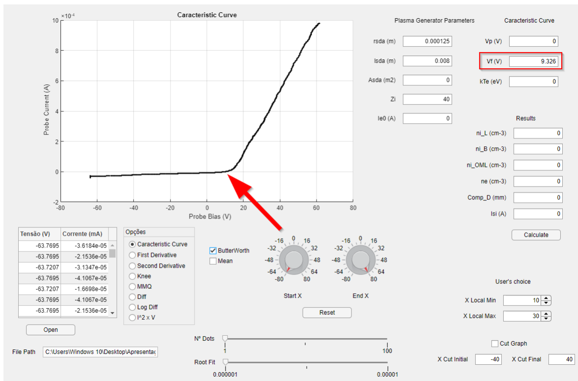
Figura 16 – Filtragem da curva característica por Butterworth e encontro de V_f .
