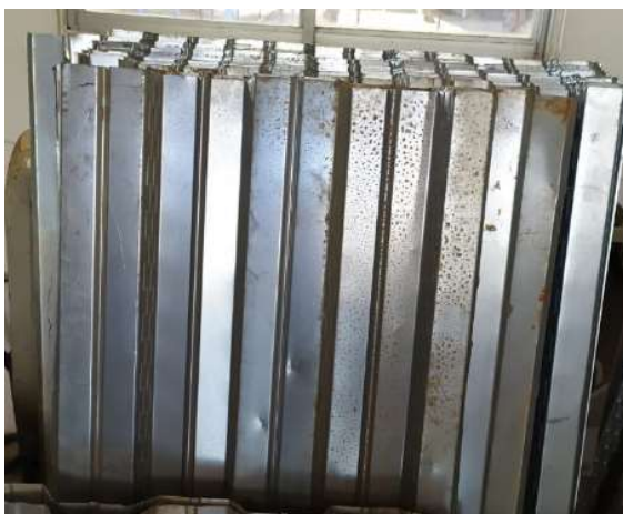
Figura 5.9: Formas das lajes tipo steel deck
