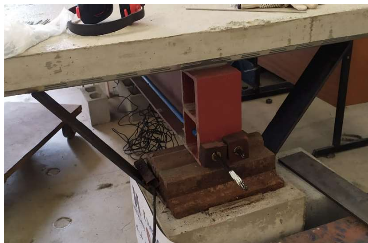
Figura 5.12: Chapas nos apoios
