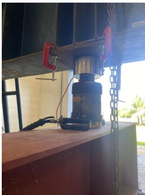
Figura 5.25: Chapa de fixação, célula de carga e cilindro hidráulico
