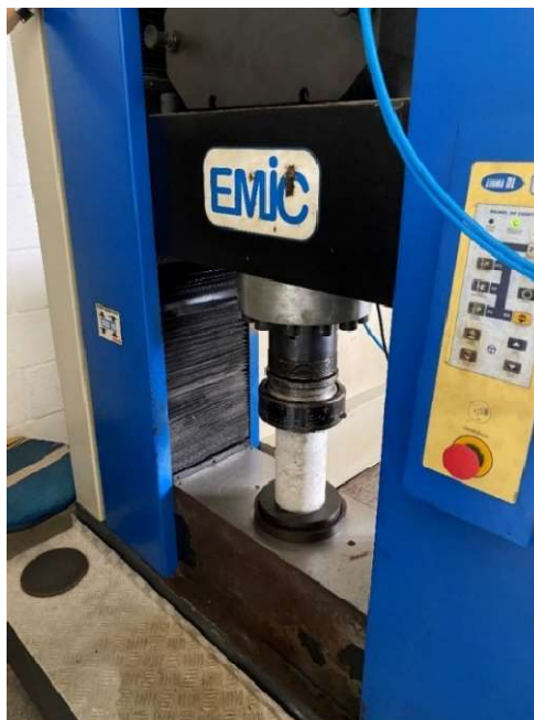
Figura 5.16: Ensaio de compressão
