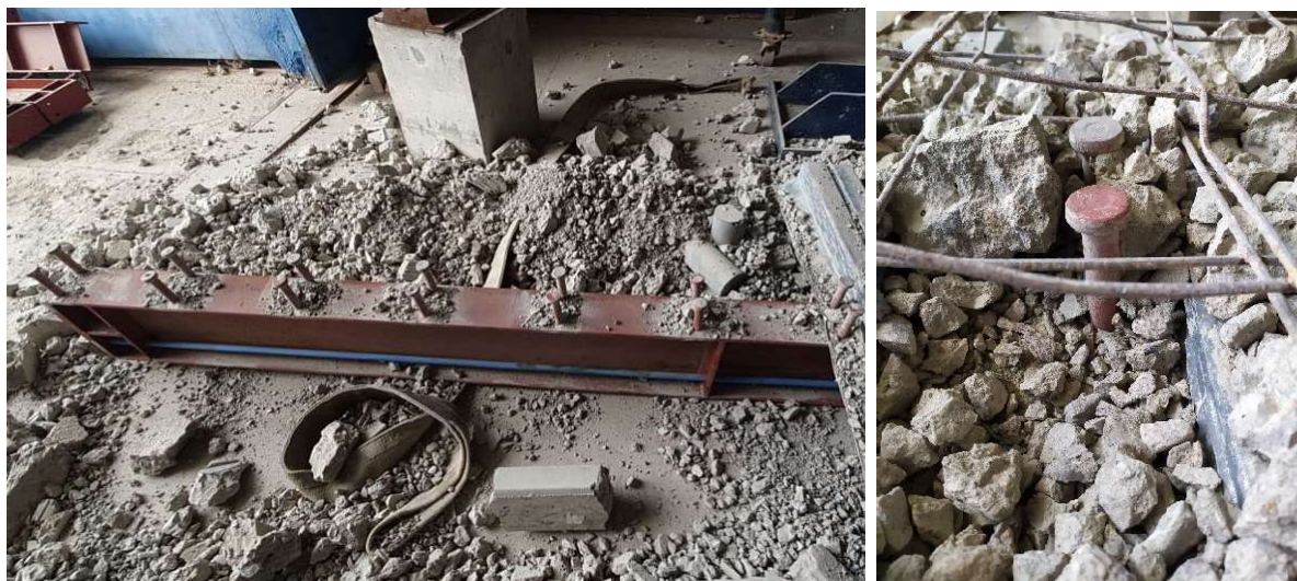
Figura 6.16: Conectores de cisalhamento após ensaio VMPP
