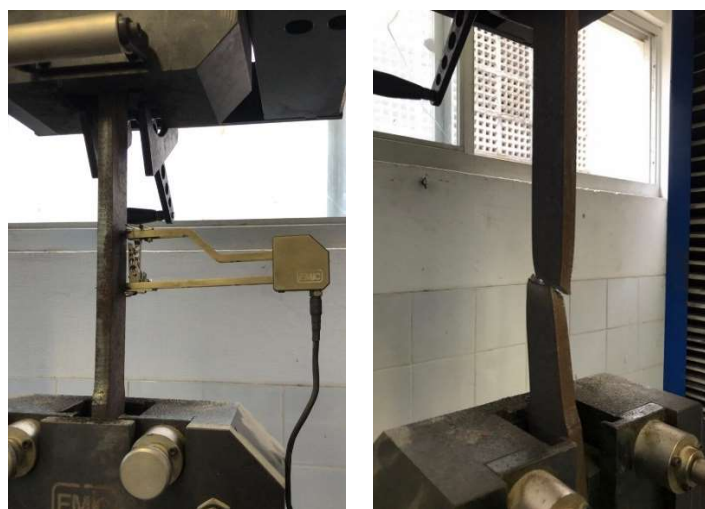
Figura 5.14: Ensaio de tração nas chapas de aço
