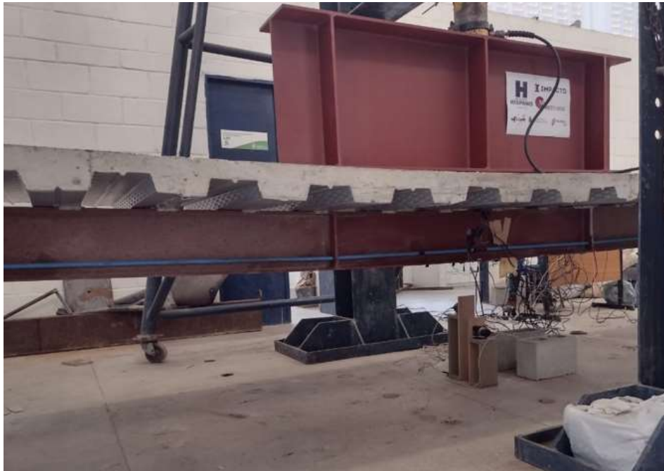
Figura 6.8: VMPR após o ensaio
