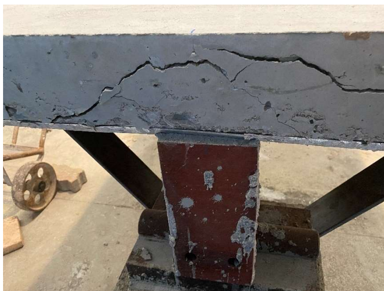
Figura 6.5: Extremidade VMC após o ensaio
