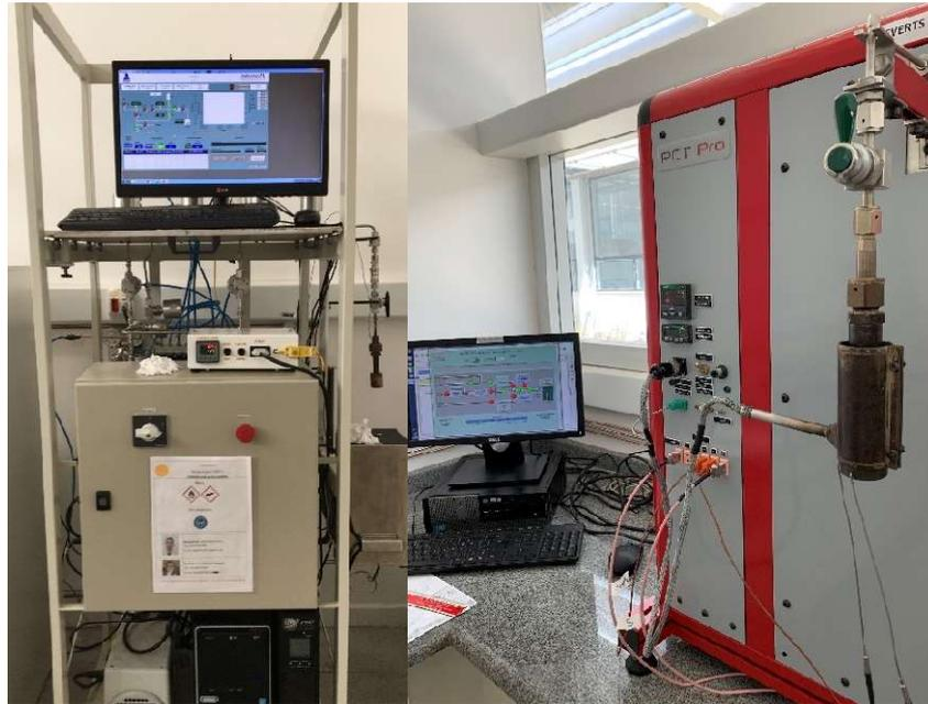
Figura 4.4 – Equipamentos volumétricos do tipo-Sievert usados para a medida de sorção de H<sub>2</sub> das amostras: a esquerda, o equipamento desenvolvido no Laboratório de Hidrogênio em Metais (LHM), e a direita o PCT-Pro da SETARAM.
