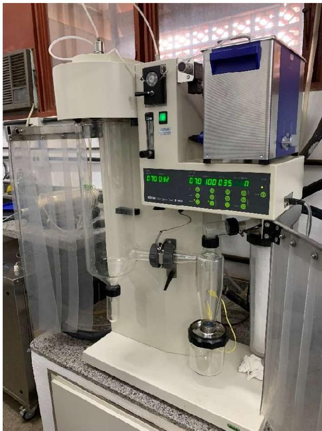
Figura 4.5 – Equipamento Buchi *Mini Spray Dryer* B-290 equipado com um *inert loop* B-295 usado nesse estudo.
