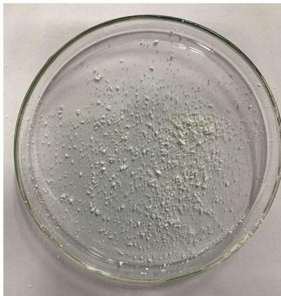
Figura 5.12 – Micropartículas obtidas por spray drying de uma solução de PEI (5%) em clorofórmio.
