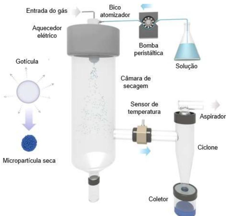
Figura 3.21 – Ilustração esquemática do processo por spray drying. Adaptado de [113].
