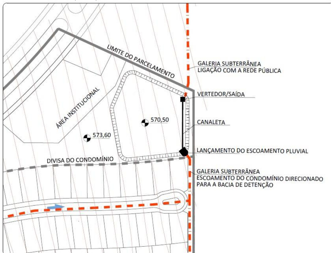
Figura 28 - Bacia de retenção do Condomínio Quinta do Golfe. Fonte: Adaptado de Engenharia e Ambiente (2006)
