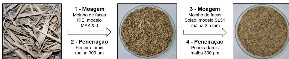
FIGURA 3.1 - Esquema da moagem da palha de cana-de-açúcar.
