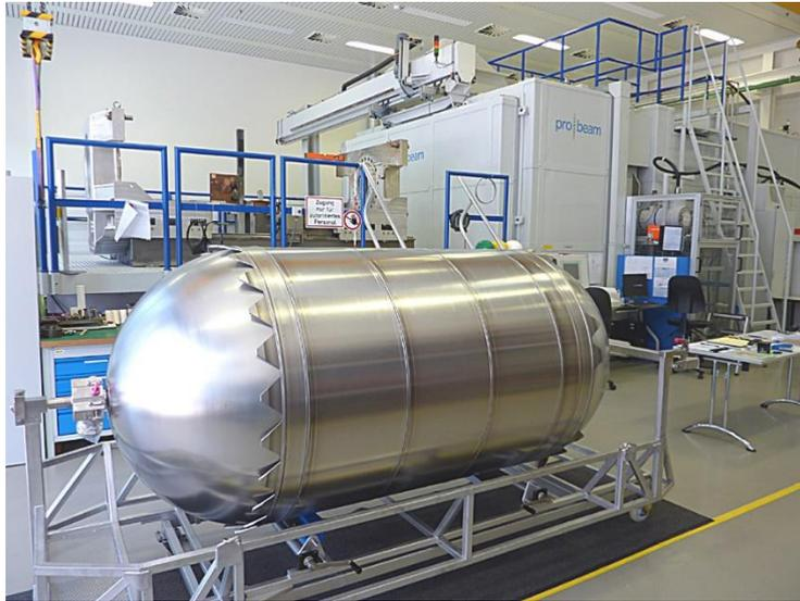
Figura 1.2 - Tanque de combustível criogênico para foguetes [9].
