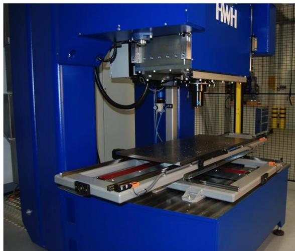
Figura 4.3 - Máquina Harms & Wende RPS200 utilizada para a produção das soldas.
