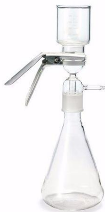
Figura 4.3 - Conjunto Millipore® utilizado na filtração a vácuo
