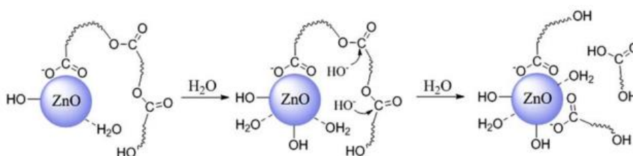
Figura 3.7 - Superfície hidroxilada da partícula de ZnO que catalisa degradação hidrolítica do PLA [50].
