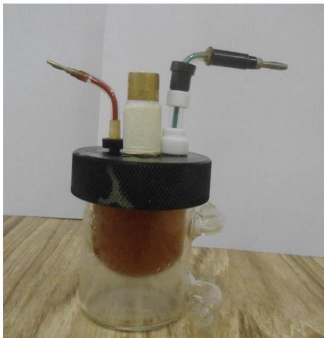
FIGURA 5-1: Célula eletroquímica.
