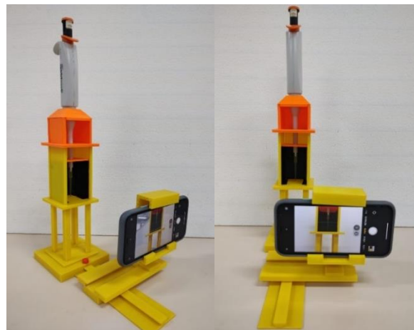
Figura 1: Fotografias do disposto completo montado e acoplado a um smartphone e a uma micropipeta para posterior utilização.
