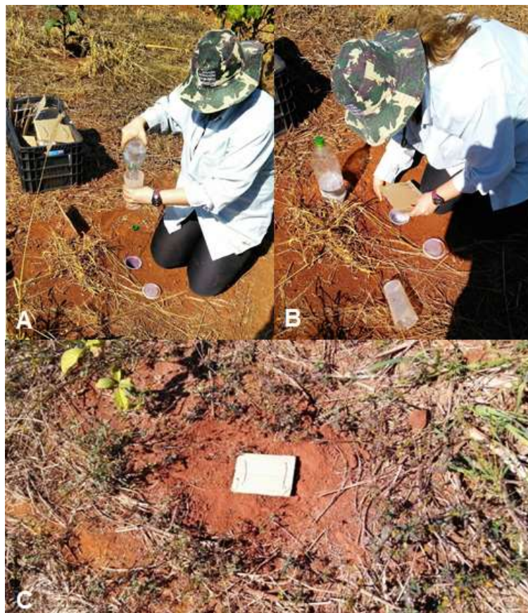
FIGURA 5. Instalação das armadilhas de solo do tipo pitfall .
