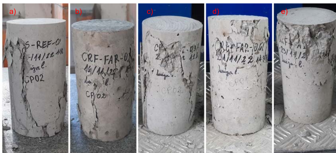
Figura 65: CP's após ensaio de compressão axial a) REF b) 0,3% FAR c) 0,3% FAI d) 0,6% FAR e) 0,6% FAI
