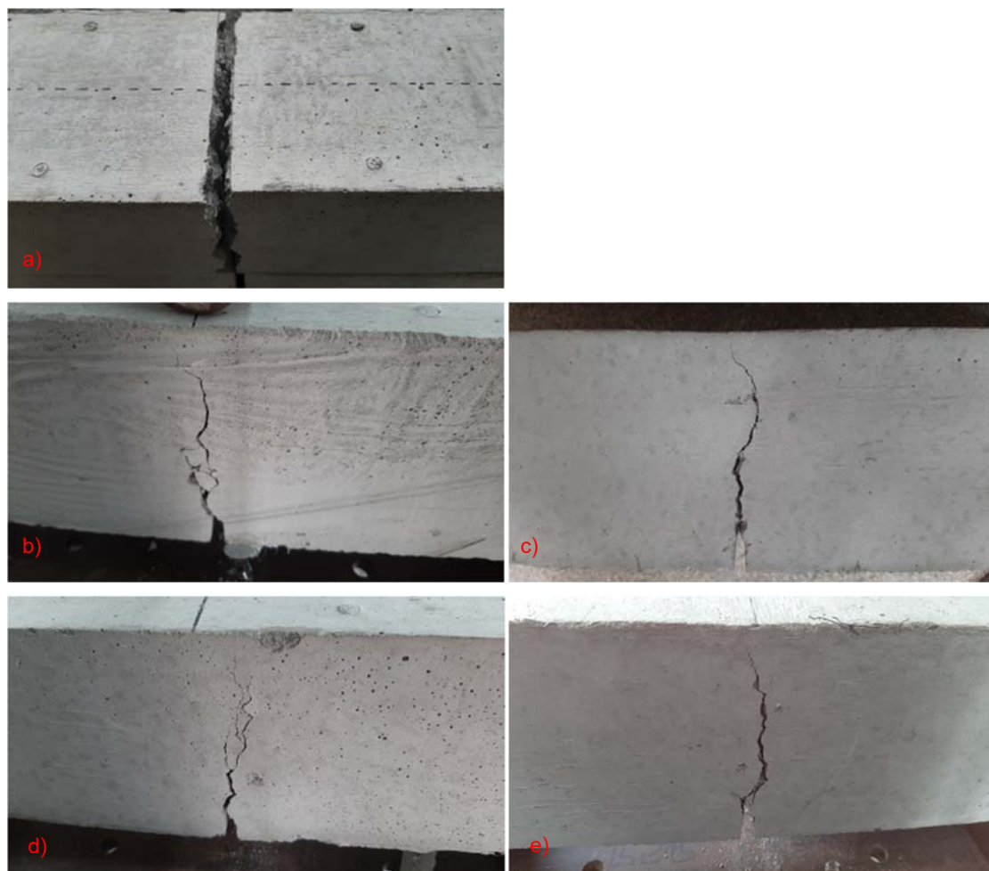
Figura 67: CP's prismáticos após ruptura por tração a) REF b) 0,3% FAR c) 0,6% FAR d) 0,3% FAI e) 0,6% FAI
