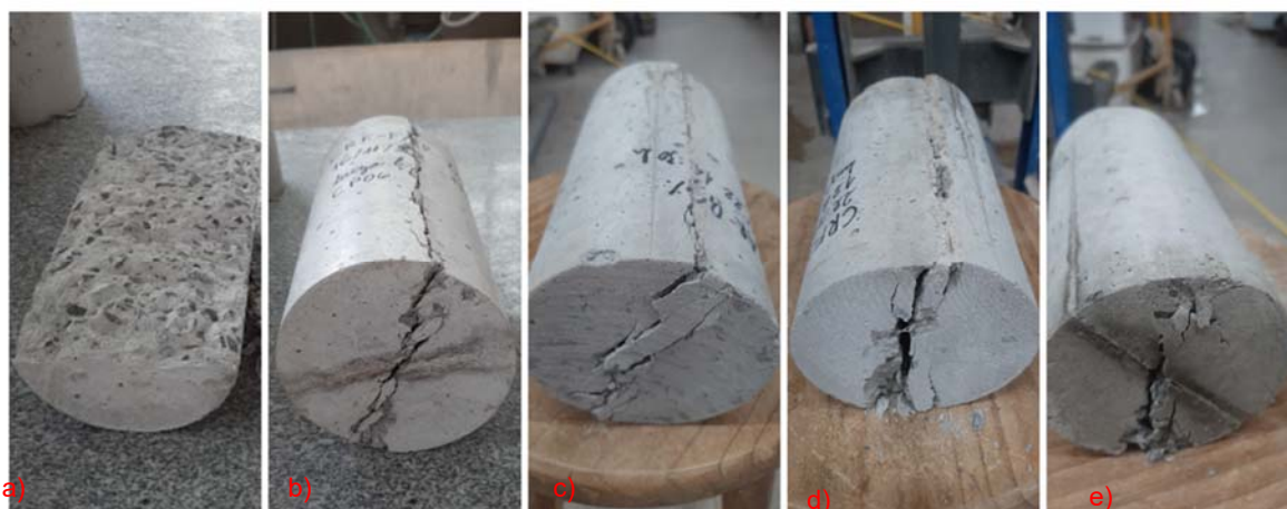
Figura 66: CP's após ensaio de tração por compressão diametral a) REF b) 0,3% FAR c) 0,6% FAR d) 0,3% FAI e) 0,6% FAI
