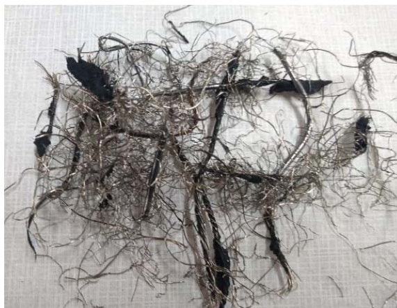
Figura 1: Material oriundo da indústria de reciclagem contendo as fibras de aço recicladas e outras partículas de materiais
