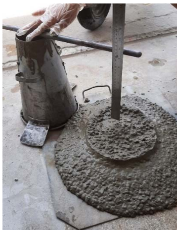
Figura 46: Ensaio de abatimento de tronco de cone
