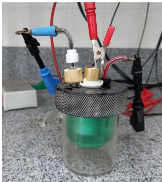
FIGURA 8-1: Célula eletroquímica de vidro tipo Metrohm para três eletrodos.
