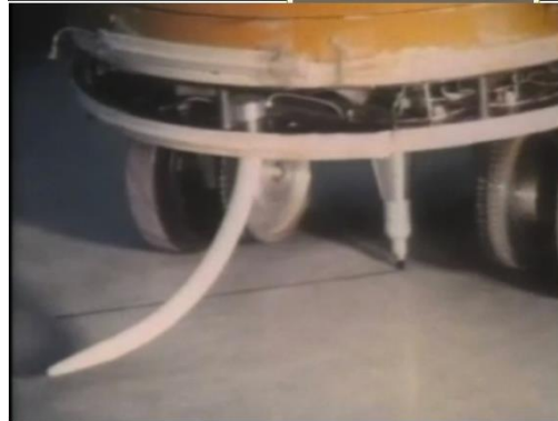
Figura 3: Detalhe da caneta no Robô Tartaruga Fonte: MPM5614_2022_LOGO_Introd.pdf (usp.br)
