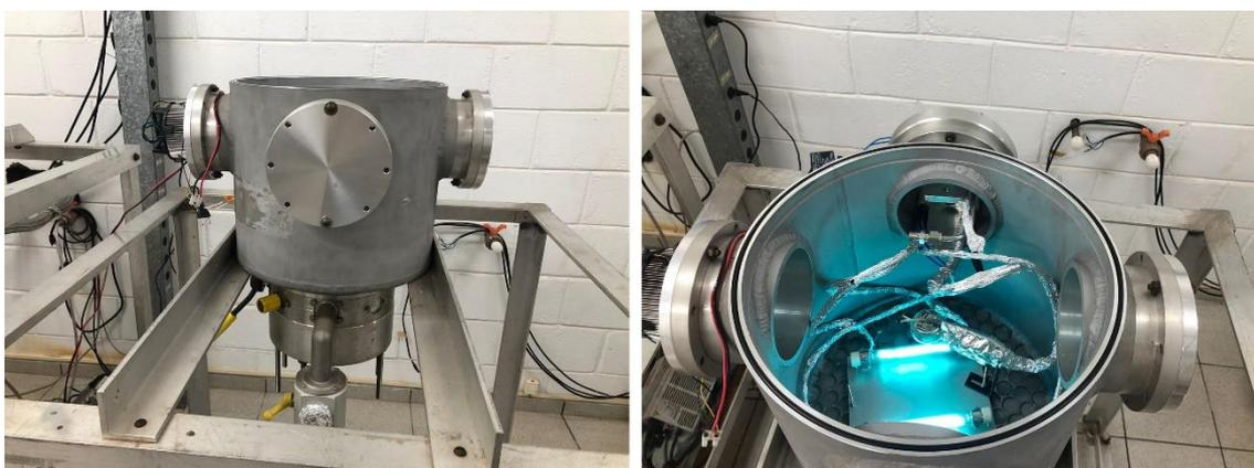
Figura 5.2 Fotos da câmara de radiação UV-C
