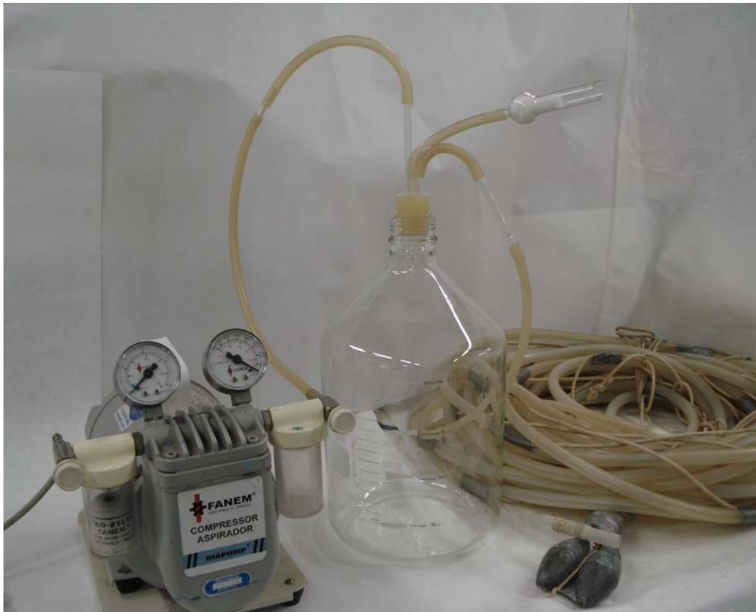
Figura 2. Sistema utilizado para coleta integrada do inóculo bacteriano (previamente autoclavado). A entrada de água C (com um peso em sua ponta) é posicionada na profundidade desejada, permaneceu fechada com papel alumínio e apenas foi aberta depois de submersa no reservatório. O tubo de vidro com algodão A , autoclavado juntamente com o sistema, é conectado à mangueira ligada à bomba de vácuo D a fim de evitar contaminação por bactérias aéreas. Um respirador B foi adicionado para controle do vácuo e manter as trocas gasosas após a coleta.
