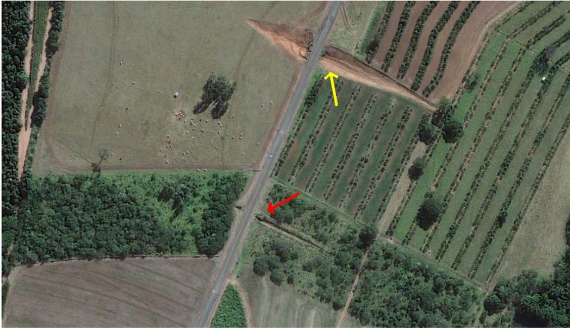
**Figura 17** - Posição dos dois túneis sobre a rodovia Guilherme Scattena. O processo erosivo é maior no túnel 2 (seta amarela) do que no túnel 1 (seta vermelha).
