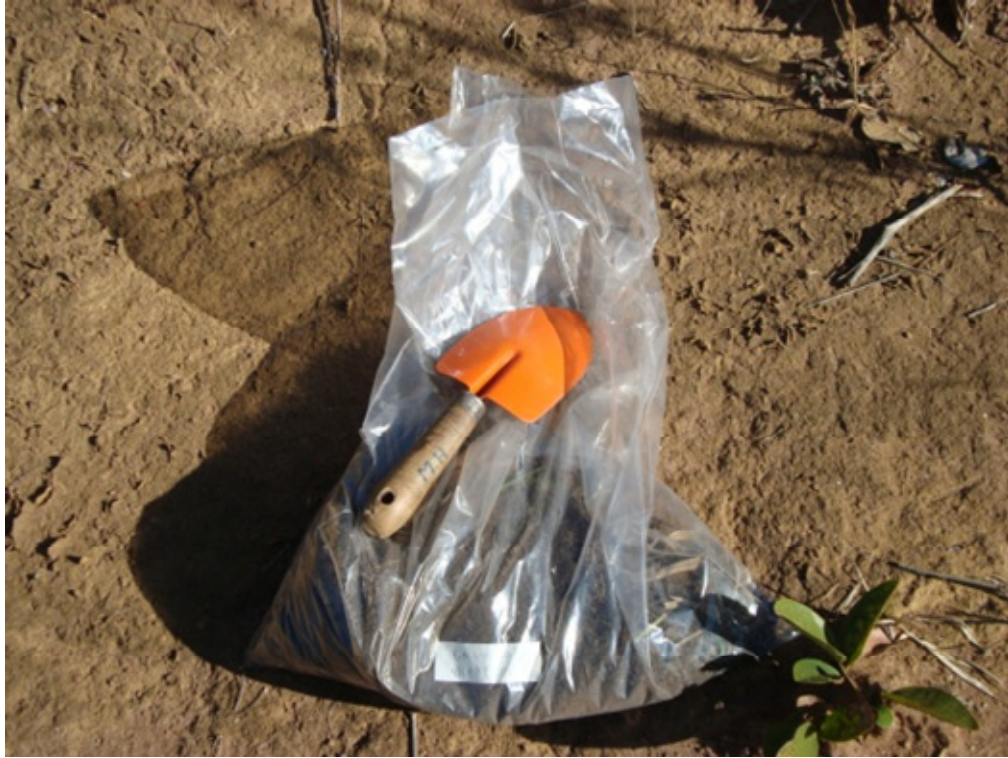
Figura 6: Material utilizado nas coletas, saco plástico com capacidade para 500 gramas de solo devidamente etiquetado e pá para coleta do material.
