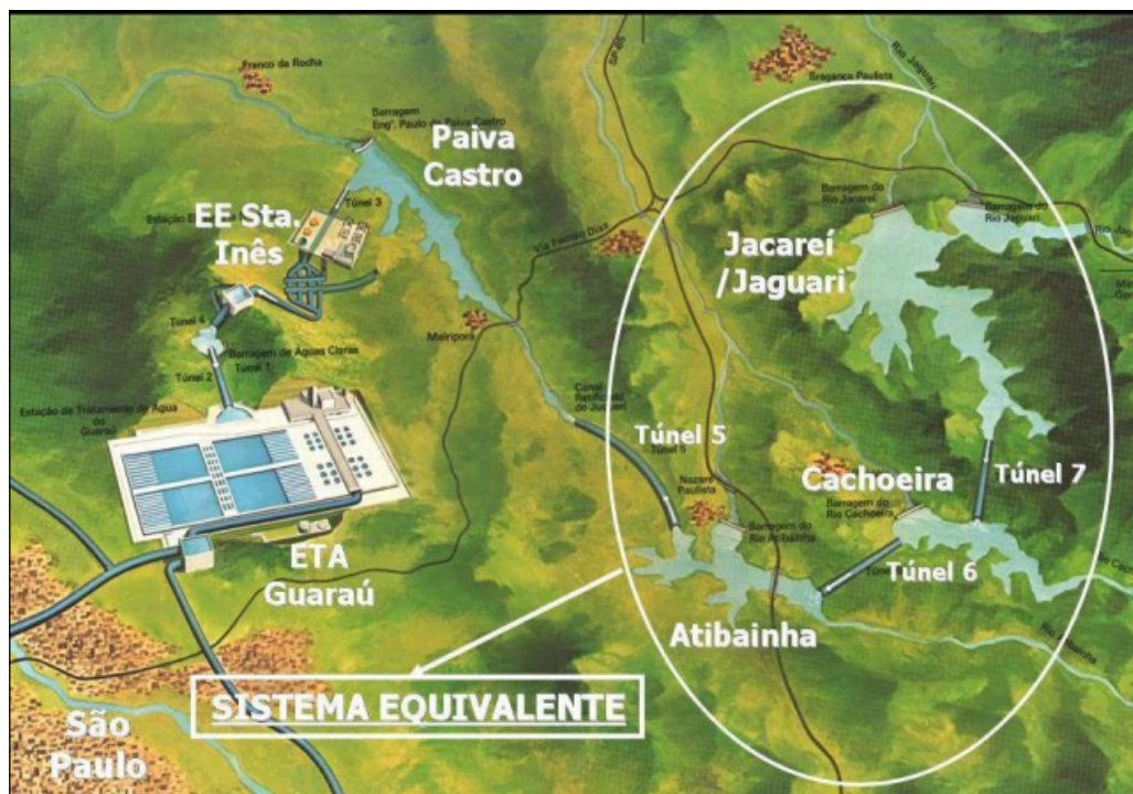
Figura 3. Diagrama esquemático dos reservatórios interligados no Sistema Cantareira (ANA, 2013).
