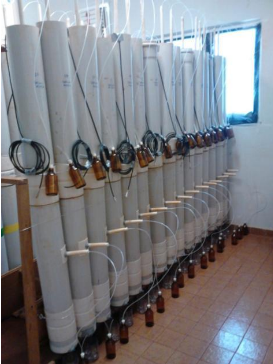
Figura 21. Aparato experimental completo, contendo 30 colunas de percolação, preparado para saturação e para receber os tratamentos com diferentes tipos de vinhaça.
