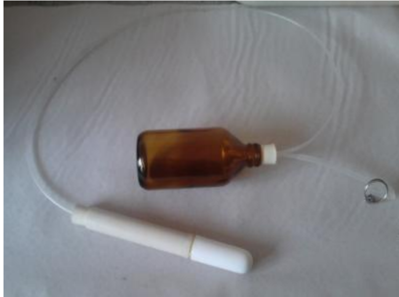
Figura 18. Extrator pronto para ser instalado nas colunas de solo.
