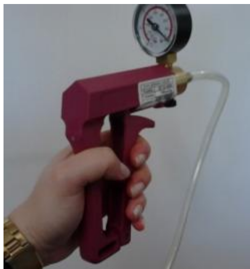
Figura 14. Bomba manual de vácuo com vacuômetro para extração da solução do solo do solo.
