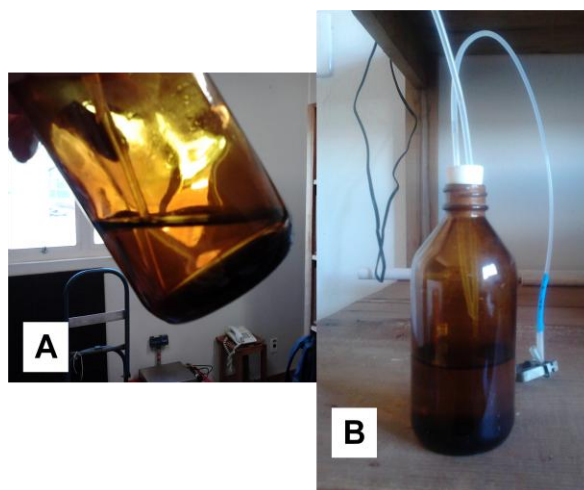
Figura 17. (A) Frasco vidro âmbar, de 200 mL, empregado no extrator de solução do solo (B) frasco de vidro, rolha de borracha e mangueras de nylon e silicone formando um sistema fechado com vácuo.
