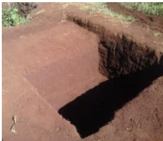
Figura 1. Trincheira de LATOSSOLO VERMELHO Eutrófico em área da UFSCar – Campus Araras - SP, usada para coleta de amostras até a profundidade de 110 cm.
