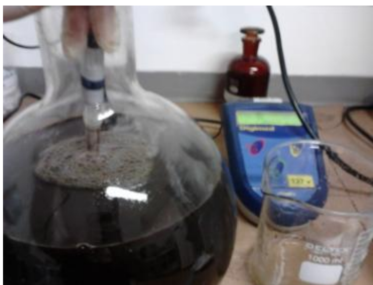
Figura 5. Ajuste e medição do potencial hidrogeniônico (pH) da vinhaça com eletrodo combinado Digimed®.
