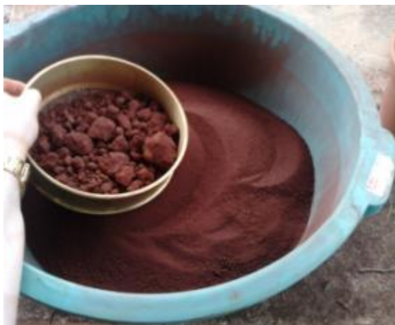
Figura 2. Preparo de amostra deformada de LATOSSOLO VERMELHO Eutrófico (LVe), seca ao ar e passada em peneira com malha de 2 mm.
