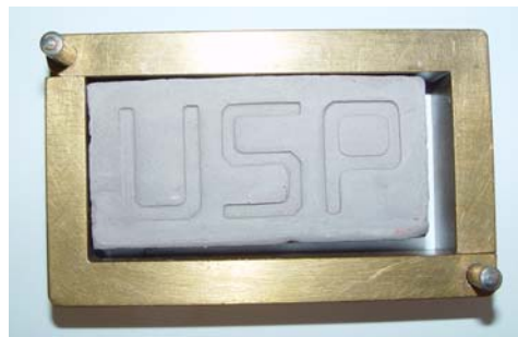
Figura 14: Retração volumétrica do tijolo após seis dias de secagem à temperatura ambiente
