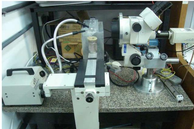
**Figura 3. 3:** Imagem do aparato da sonda termoelástica TEProbe<sup>®</sup>, utilizada para deposição de filme de polianilina sobre a superfície dos microcantilevers.
