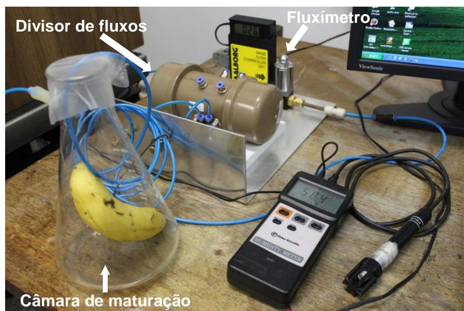
**Figura 3. 9:** Imagem do sistema construído para a divisão de fluxos, juntamente com um fluxímetro comercial e a câmara (para inserção das frutas durante o amadurecimento).
